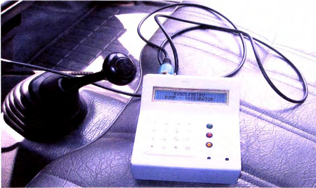
Figura 3.4 Unidad de adquisición de datos del Rugosimetro Bump Integrator
