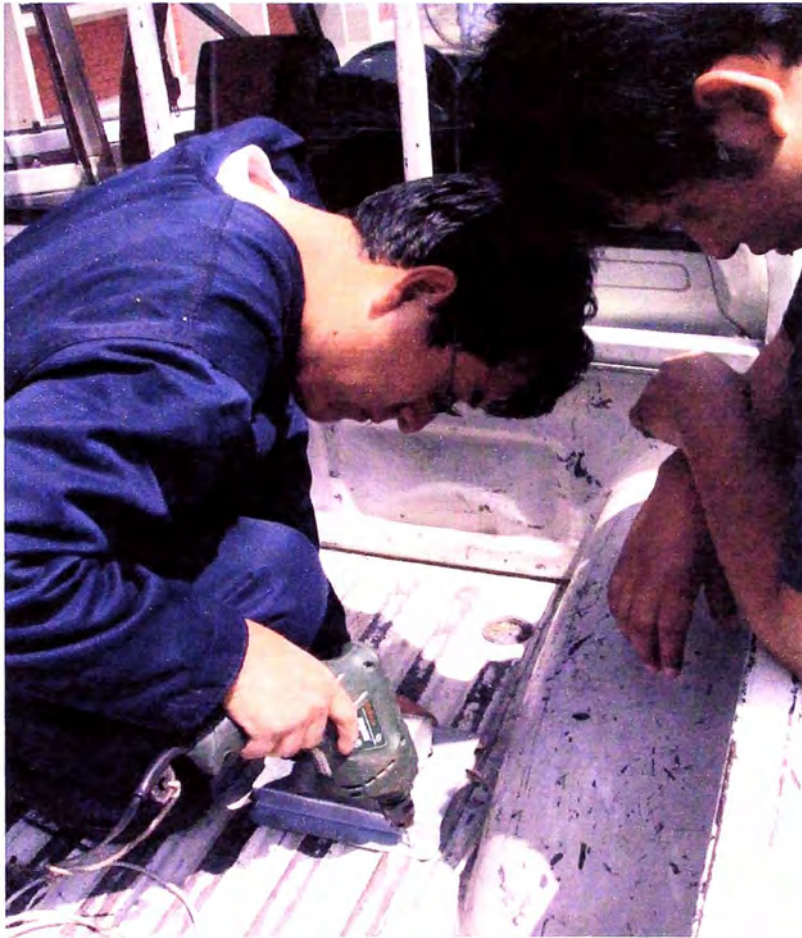
Figura N° 3.10 Instalación del Sensor de Desplazamiento en el vehículo
