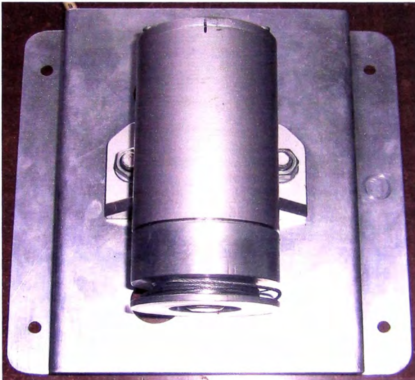
Figura N°3.8 Sensor de Desplazamiento - Bump Integrator
