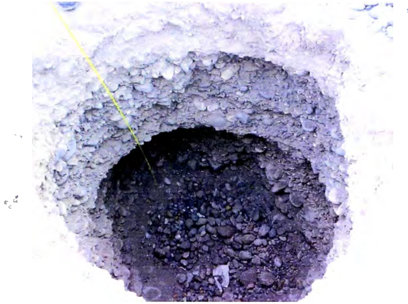
Foto N° 1.02: Calicata realizada para estudio de suelo
