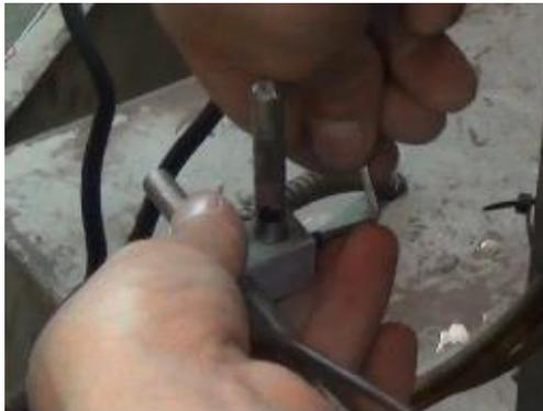
PASO 11. Dejar que la cadena transporte a las ampollas hasta que los rodamientos de valona eleven a una de ellas y detener el avance de la cadena dando un giro a la derecha al selector.
