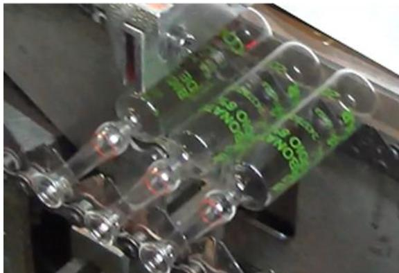
PASO 15. Retirar las 3 ampollas y colocar el porta- pantalla, ajustar las perillas de ajuste porta-pantalla. Verificar la inclinación de la malla con el cuerpo de la ampolla; para nivelar el marco porta-pantalla ajustar el perno hexagonal para inclinación con llave mixta 10.
