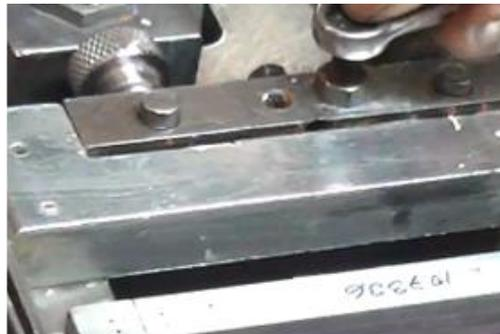
PASO 8. Retirar el porta-pantalla. Retirar las ampollas, excepto la que se encuentra encima de los rodamientos con valona para verificar la distancia de la pantalla al cuerpo de la ampolla.
