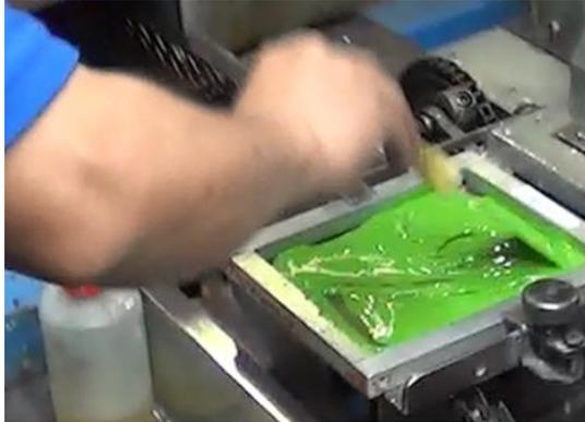
PASO 21. Bajar la espátula y colocar ampollas en la cadena para realizar las pruebas de impresión.
