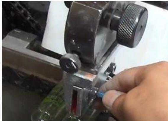
PASO 14. Colocar 3 ampollas en la cadena desde la fibra óptica hasta que los rodamientos con valonas eleve a una de ellas y luego detener el avance de la cadena dando un giro a la derecha al selector. Nota: para hacer más presión al cuerpo de la ampolla con respecto a la goma graduar con la perilla del elevador
