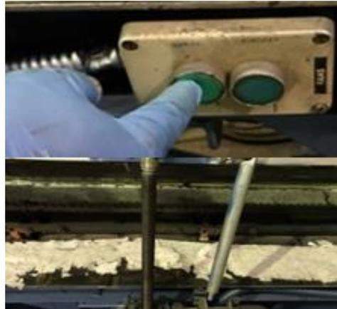
PASO 3. Desajustar los pernos (4 a lo largo del horno) de la cadena fija con llave mixta N°17.
