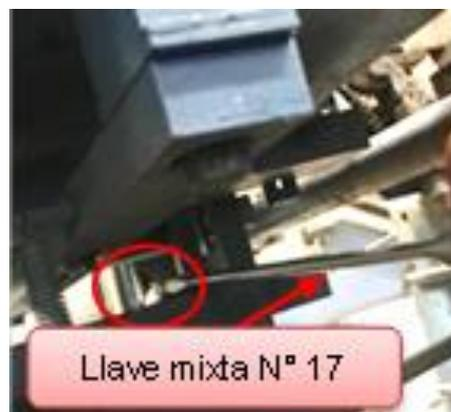
PASO 5. Ajustar manualmente la **distancia** entre la cadena fija y la móvil según la capacidad de la ampolla. Para ello usar una ampolla como patrón y mover la cadena fija para que esté por debajo de la zona de impresión de texto, y la cadena móvil para que esté por encima del aro de identificación y/o punto de cierre.
