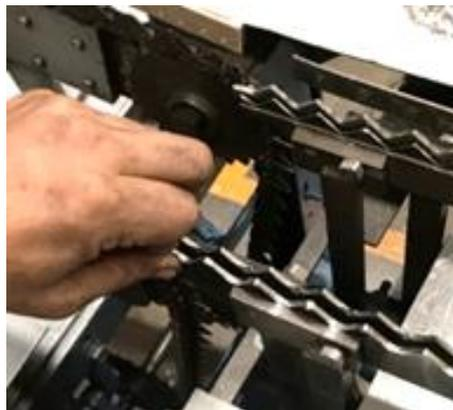
PASO 9. Verificar con una regla metálica si la altura de los peines a lo largo de la cadena es la adecuada según la capacidad de la ampolla.
