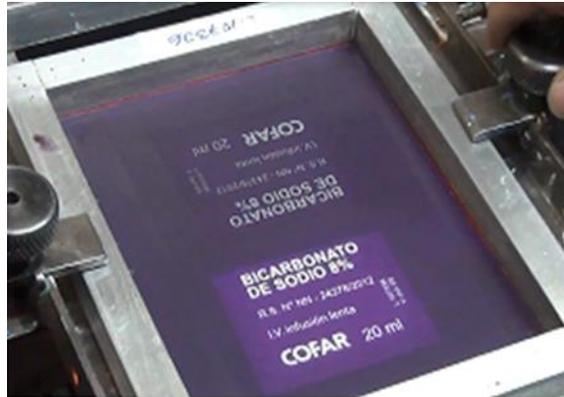
PASO 5. Colocar 3 ampollas para ver la distancia del cuerpo con respecto a la pantalla y al porta-pantalla (1 ampolla debe estar encima de los rodamientos con valona).
