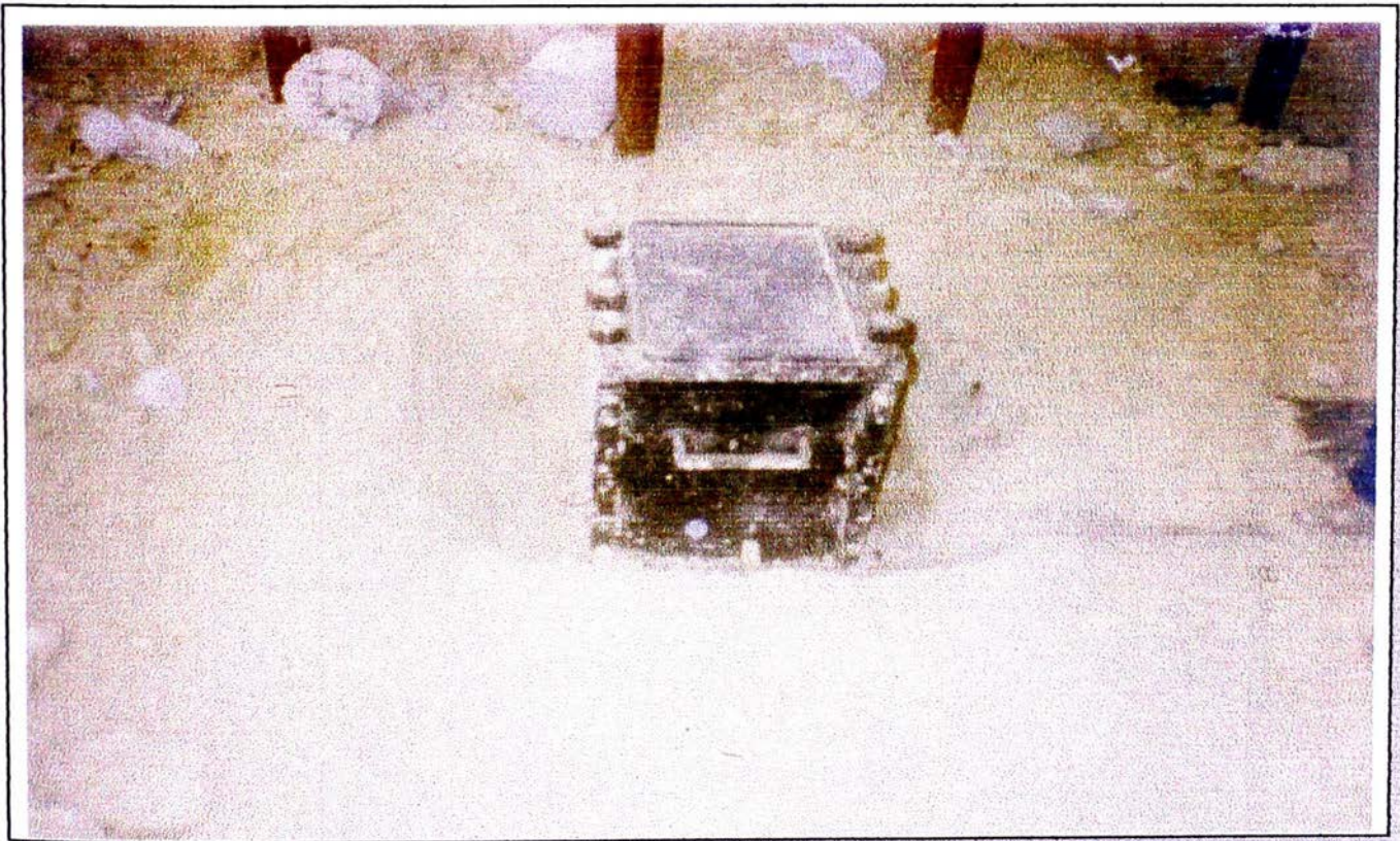
Foto N°18 Vista mostrando al espécimen colocado dentro de la caja metálica (confinamiento)
