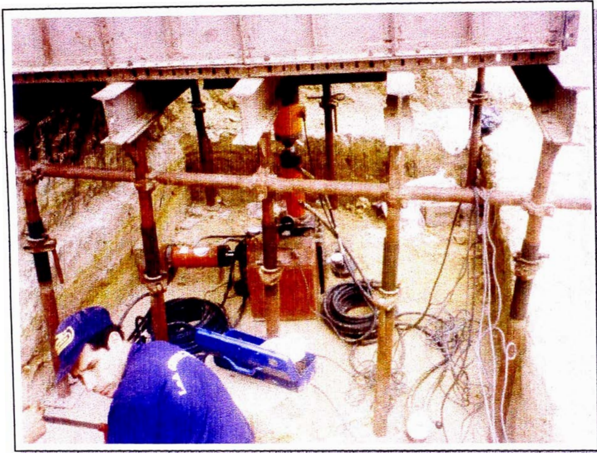
Foto N° 19 : Vista mostrando la gata vertical para la transmisión de la carga (confinamiento del espécimen) y la gata horizontal para el esfuerzo tangencial (romper el espécimen ) los extensómetros para el registro de deformaciones
