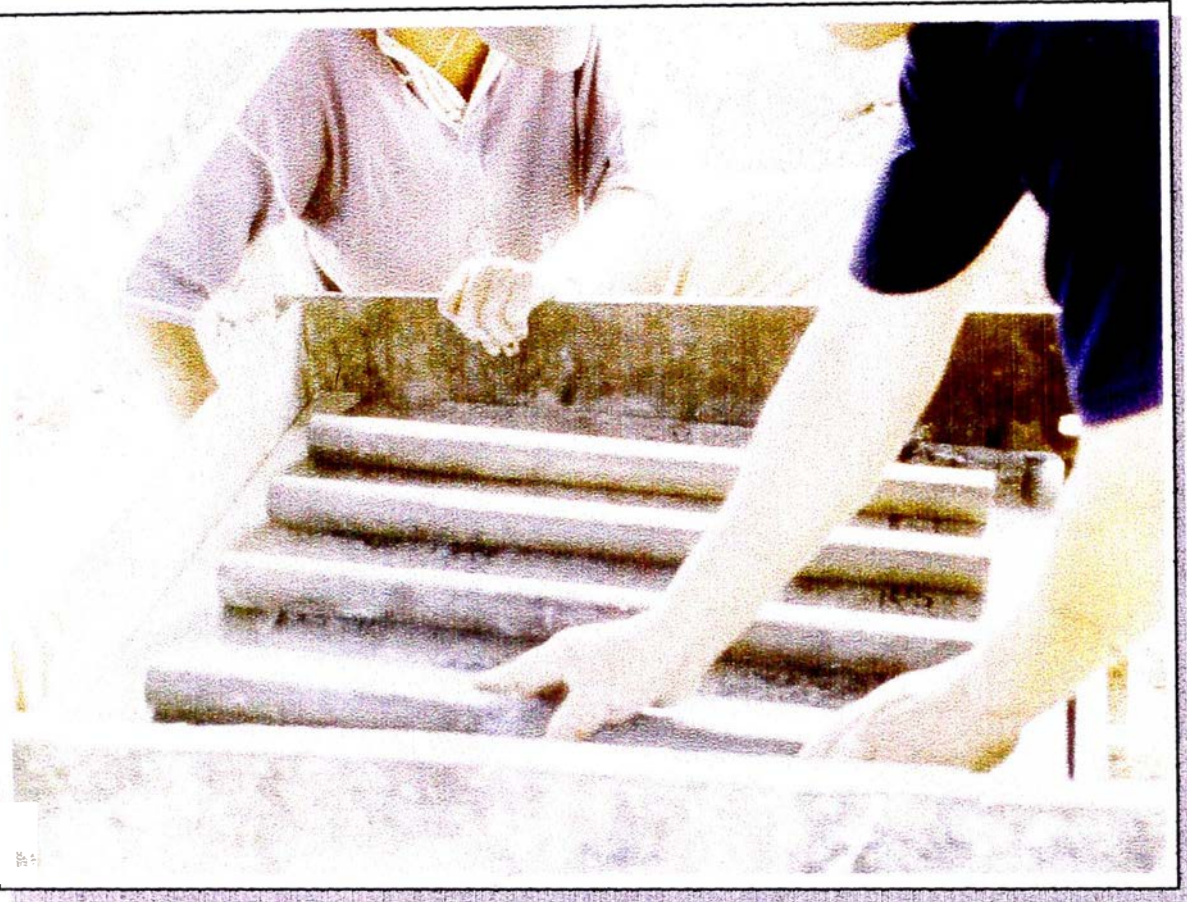
Foto Nº 5 : Vista mostrando la colocación de pines sobre la plancha metálica para aminorar la fricción al momento de hacer el ensayo (romper el espécimen)
