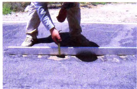
Foto 05: Se observa una falla tipo Hinchamiento de severidad baja. Foto 06: Se observan varias fallas consecutivas tipo Huevo de severidad Baja. (km 90+100 – Km 90+300)
