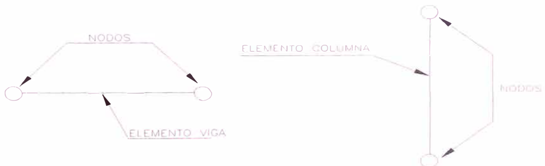
Figura N° 3.13 Elementos Unidimensionales con Nodos Rígidos.
