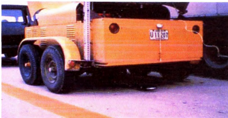
Figura 2.4 Equipo Deflectómetro Dinámico de Balanceo.
