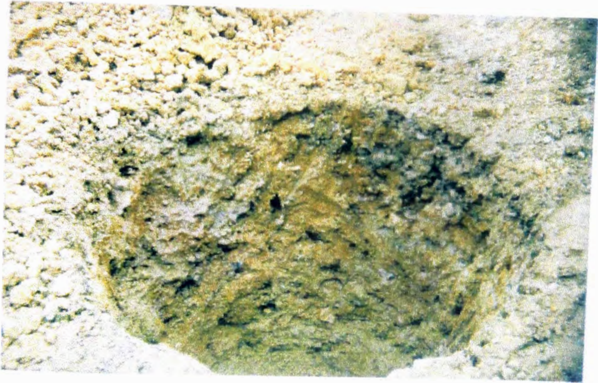
FOTOGRAFIA N°3. EXCAVACION PARA LA TOMA DE MUESTRAS
