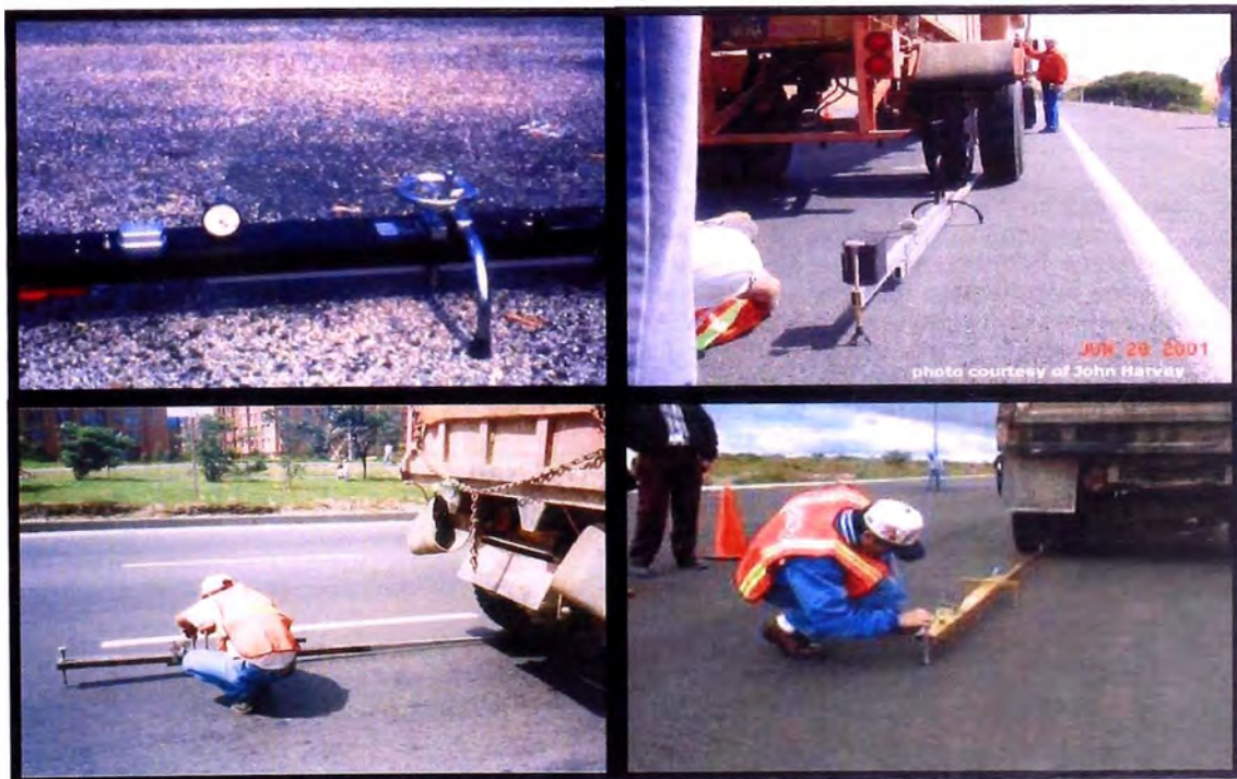
Gráfico 2.12 Medición de Deflectometría con viga Benkelmann
