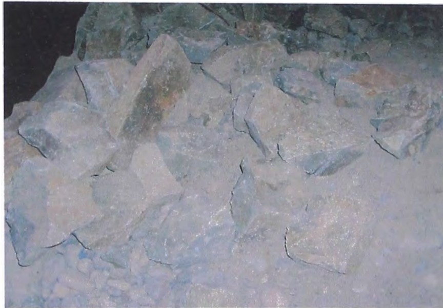
FOTO N° 16: Piedra que se empleará en la construcción de un muro de mampostería, la dureza debe ser como mínima de 4 según la escala de Mohs.
