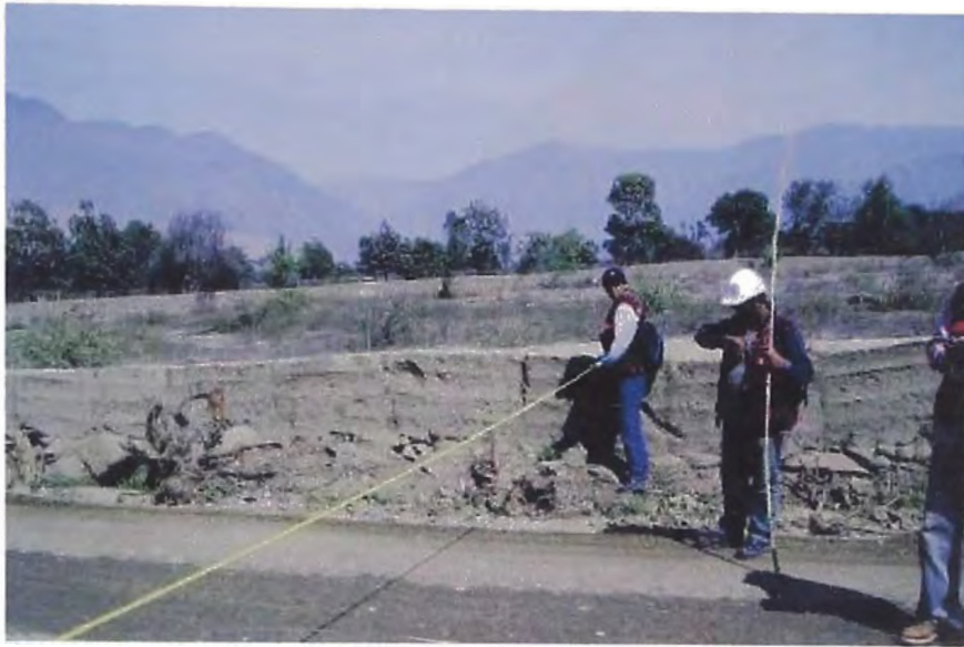
FOTO N° 3: Reconocimiento del ancho de la plataforma en el inicio del tramo medición del ancho libre total.
