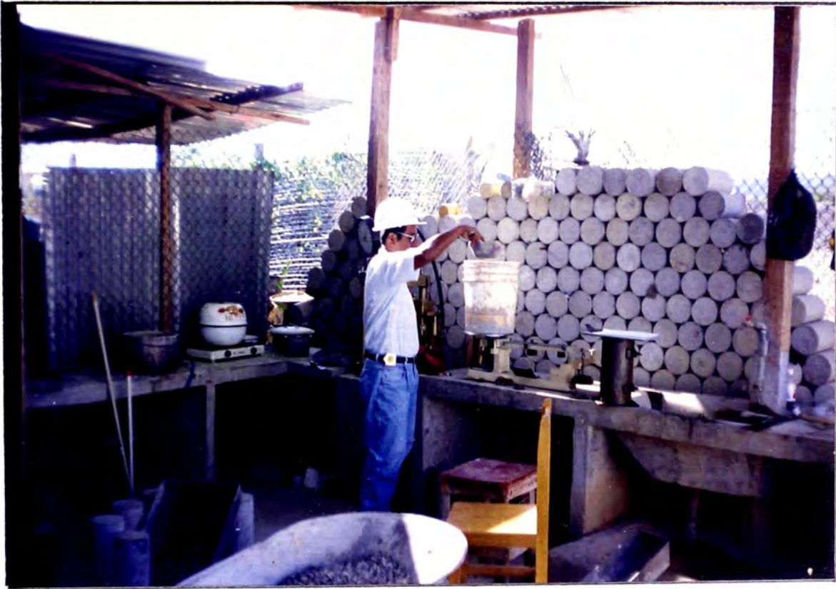
Granulometría : pesaje de los agregados, para luego tamizarlos.
