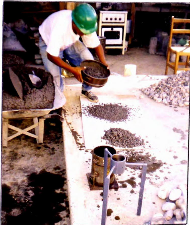
Control de tiempo de endurecimiento, secuencia del tamizado de una muestra de mortero, representativa del concreto fresco.
