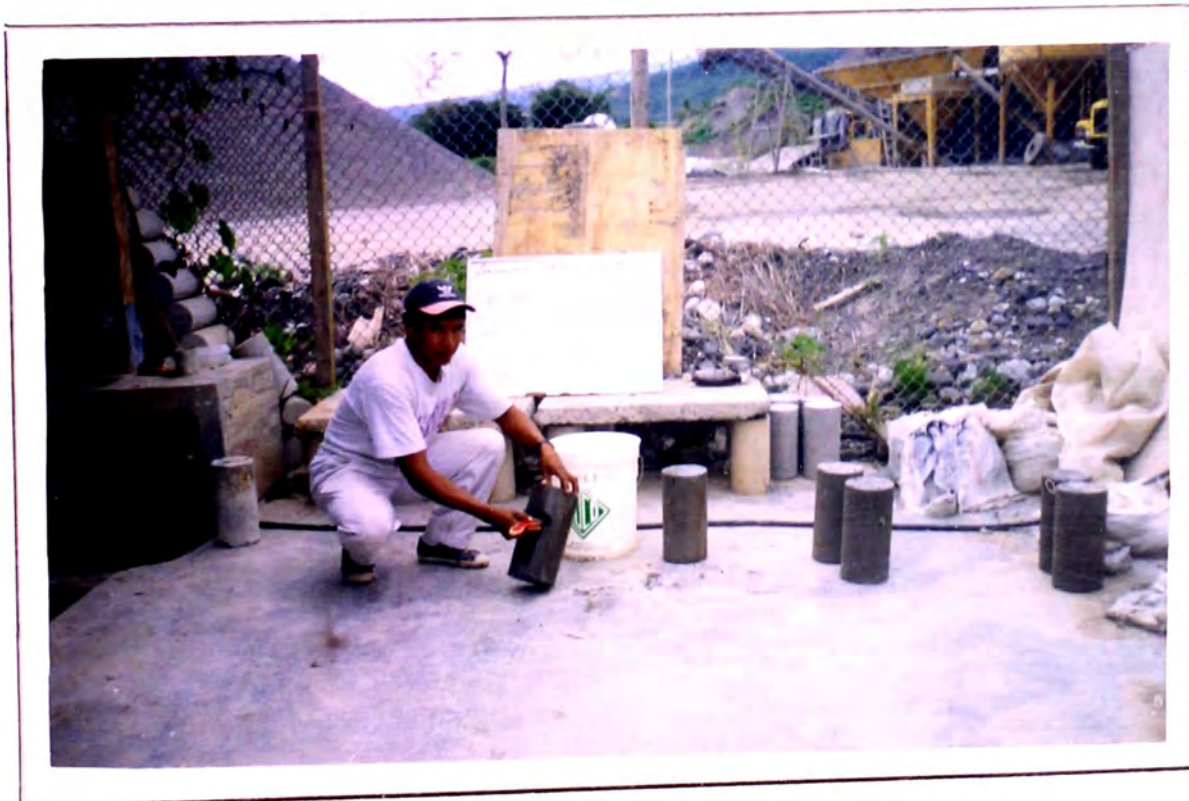
Aplicación del curador químico "KUREZ QS", formando una membrana impermeable. Se aplico una y dos capas de curador.
