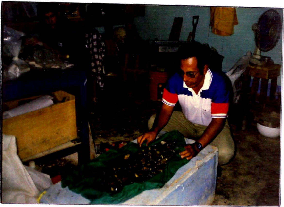
Prueba para la determinación de la humedad superficial de los agregados.
