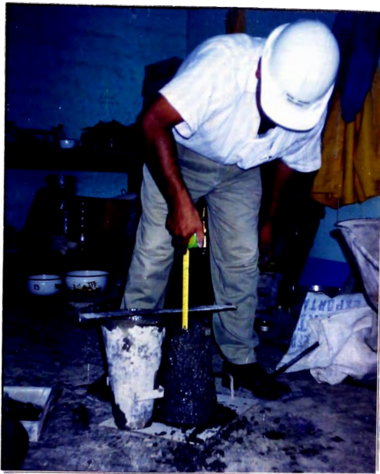
Medida de la consistencia del concreto fresco, mediante el ensayo del Cono de Abrams.
