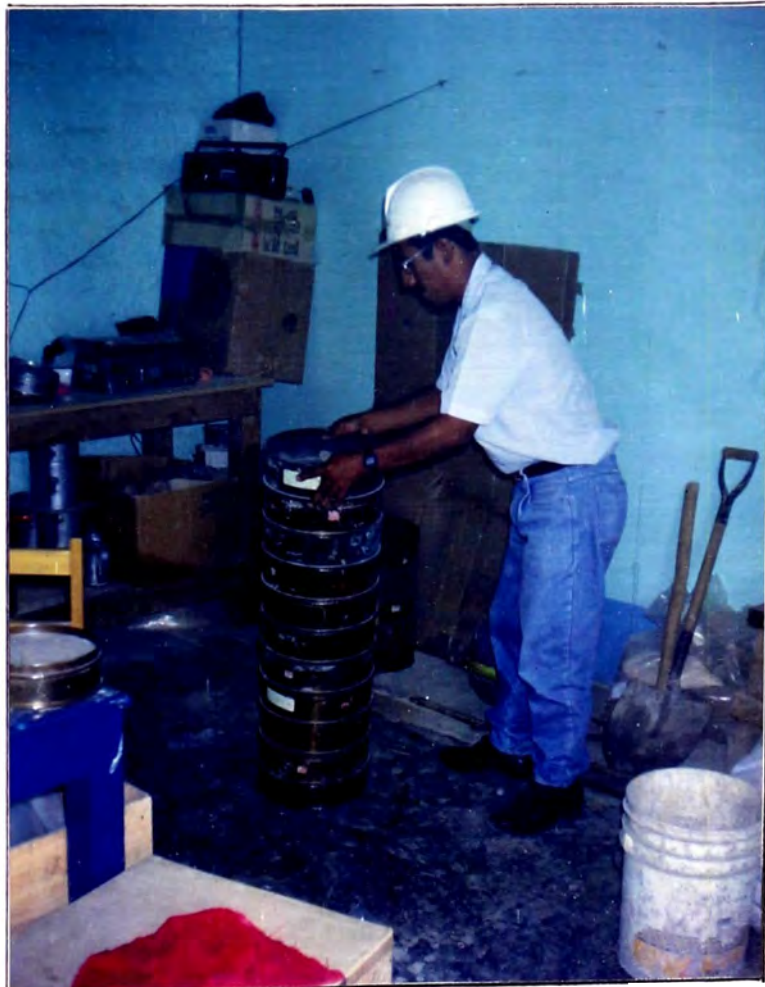
Proceso de zarandeo para obtención de la granulometría de los agregados.
