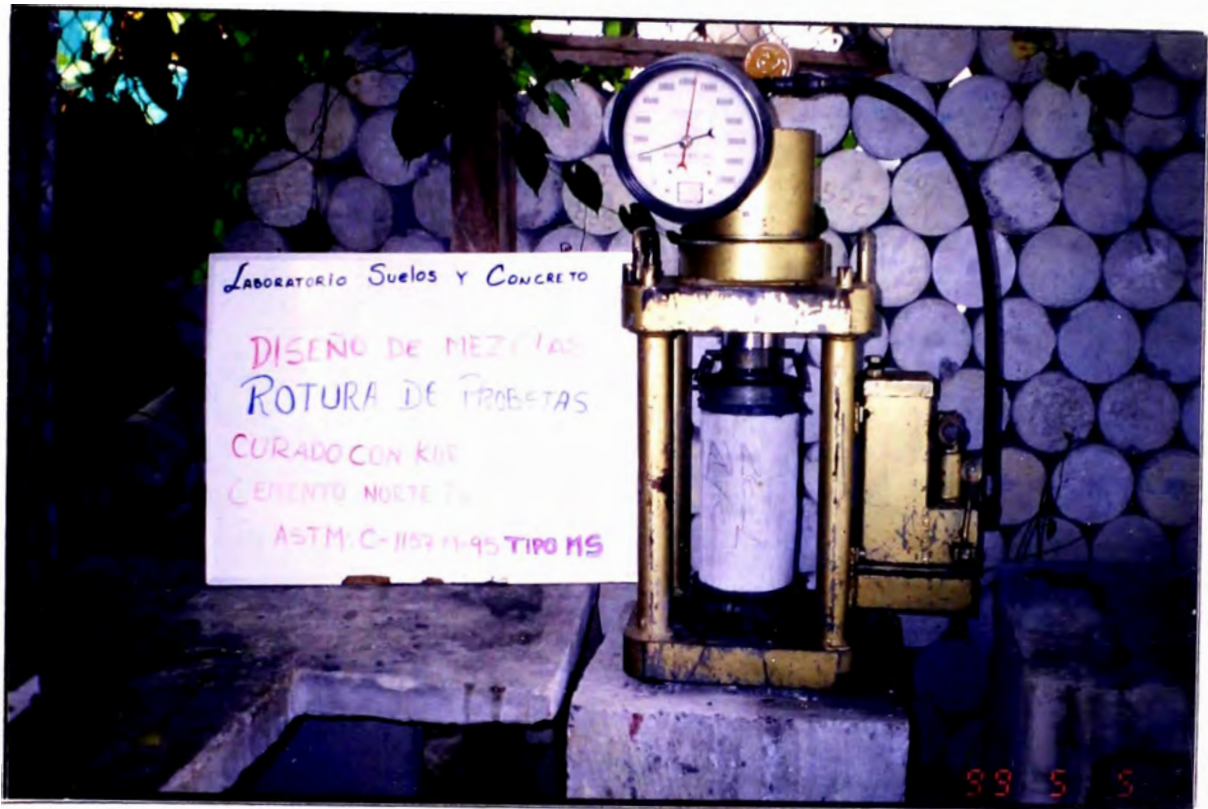
Ensayo de resistencia a la compresión, equipo prensa rompeprobetas.
