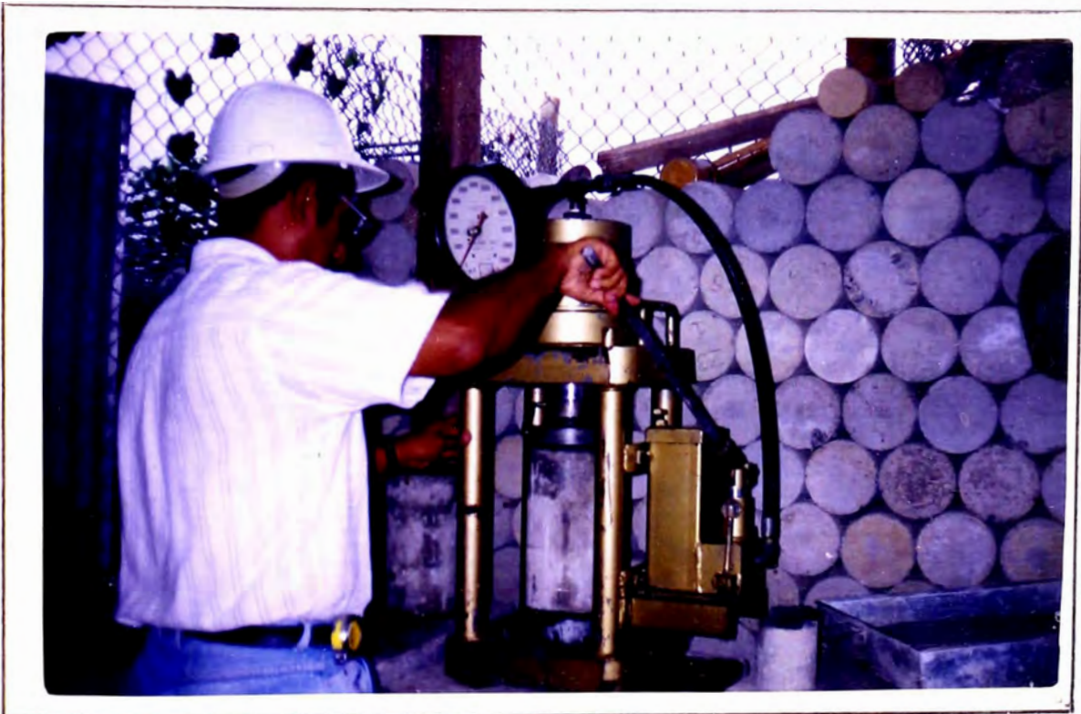
Prueba de compresión de probetas de concreto.
