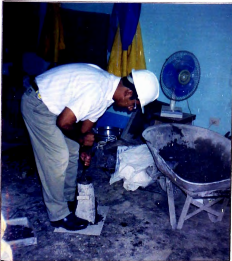
Ensayo de consistencia del concreto, prueba para determinar el comportamiento del concreto fresco que define el grado de humedad de la mezcla.
