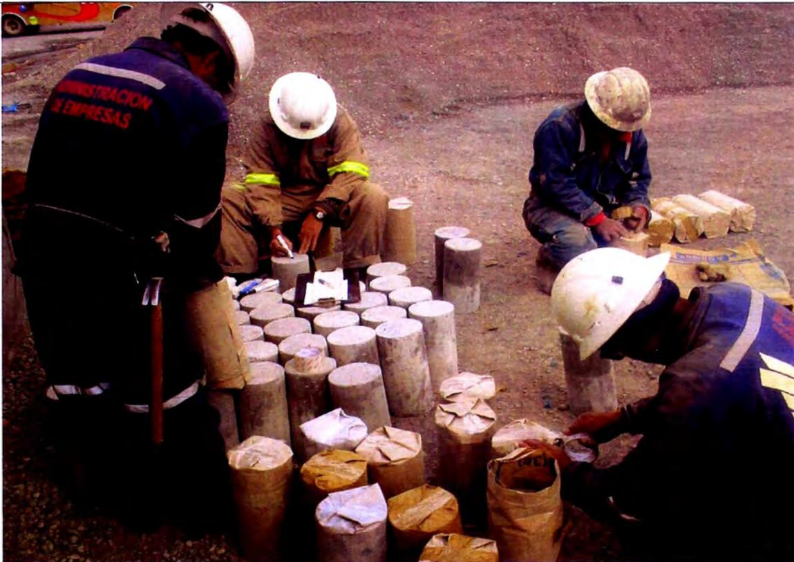
Foto N° 20: Empaquetadura de probetas para transportarlas al laboratorio.
