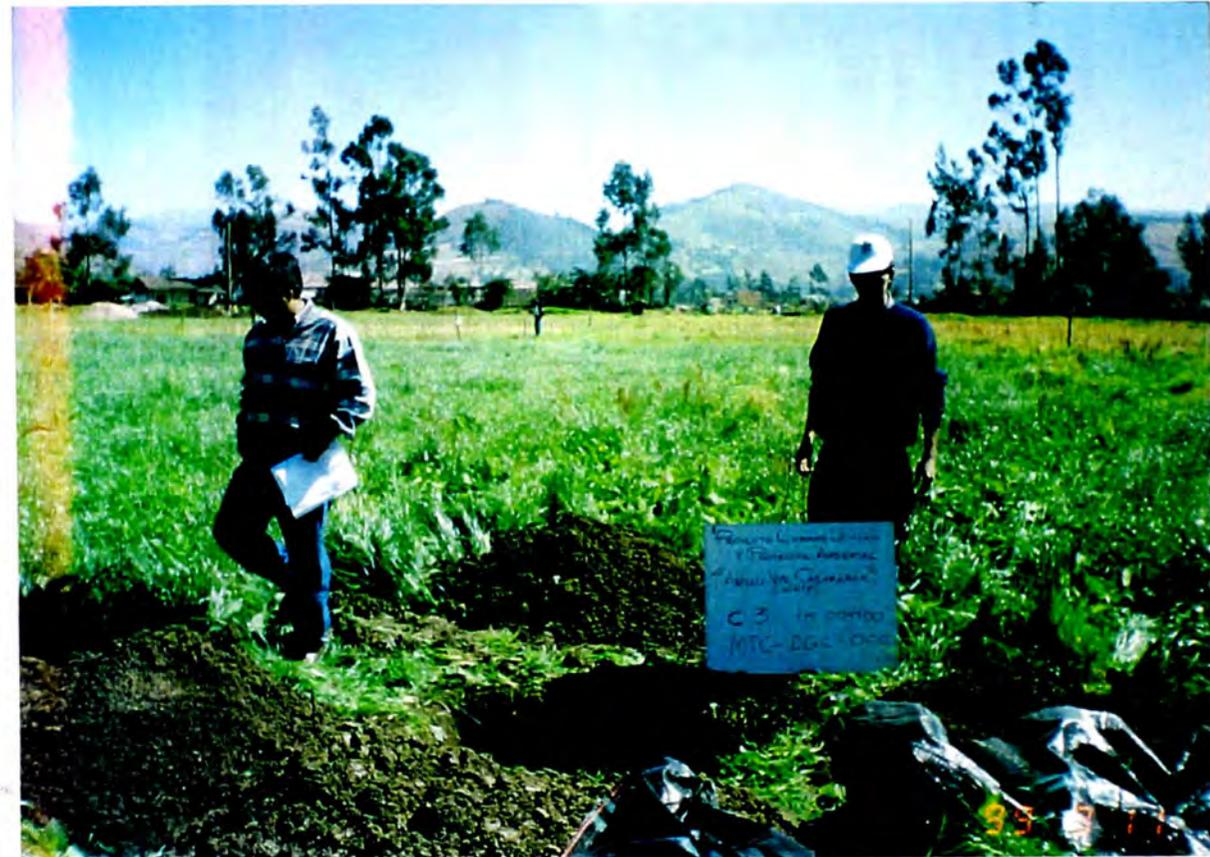
**C-3, km 00+400:** Obsérvese la presencia de material fino (CH) característico en todo el tramo; así mismo se observa que el tramo atraviesa terrenos de cultivo.
