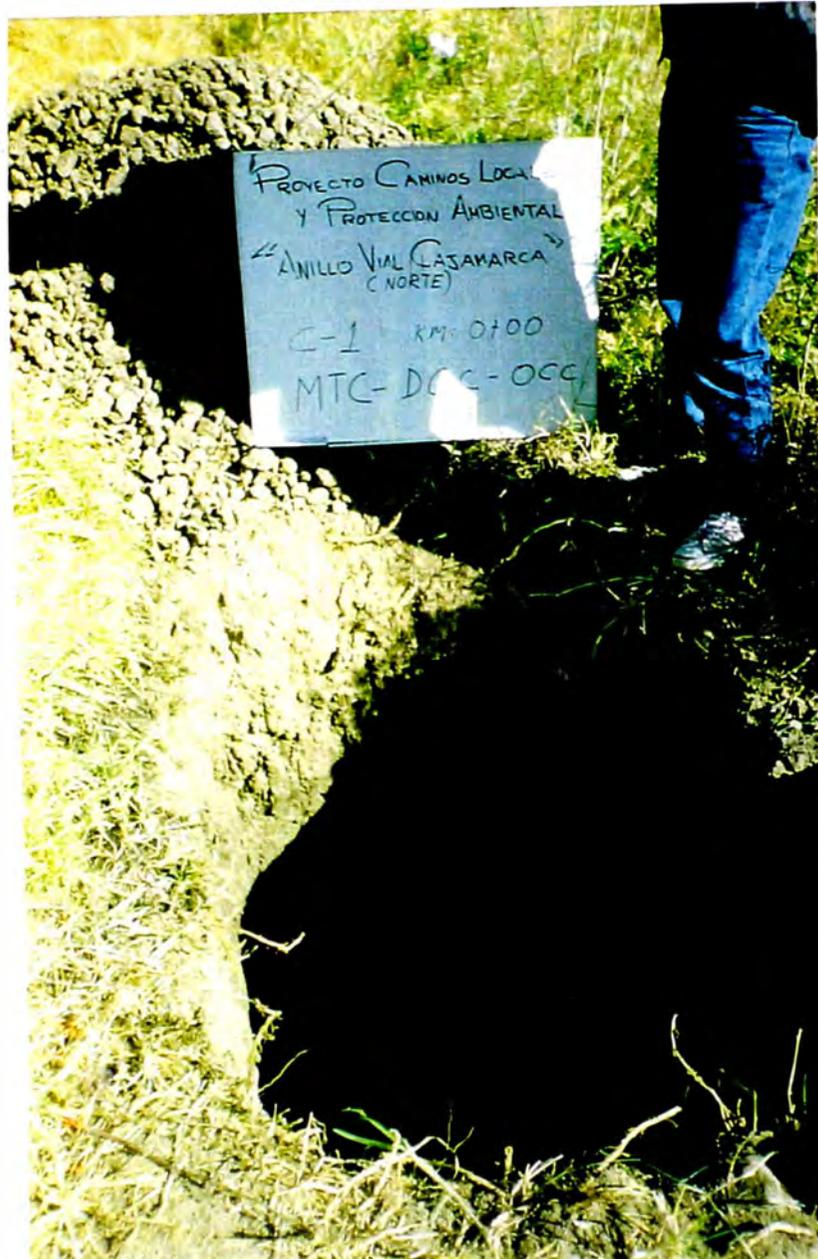
**C-1, km 00+000:** Obsérvese la presencia de material fino (CH), en el suelo de fundación.
