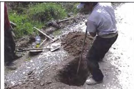
**FOTO N° 7:** De 0.40 a 1.20 se encontró suelo granulares con finos y con presencia de gravas con tamaños máximos de 2 1/2" de forma sub angulosas
