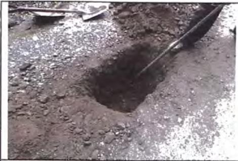
**FOTO N° 6:** Calicata de 1.20m de profundidad, lado derecho de la vía Km 165+740., los primeros 0.40m se encontró material granular sub angulara tipo afirmado, conformado por gravas con tamaños máximos de 1" de formas sub angulosas.
