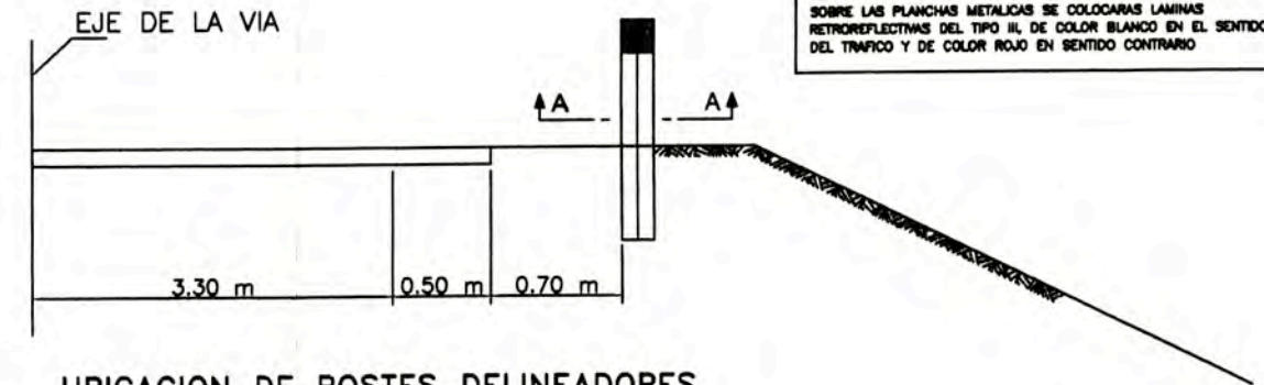
UBICACION DE POSTES DELINEADORES
