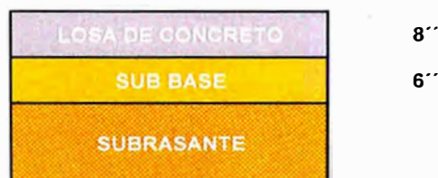
Figura 5.4 Estructura del Pavimento rígido: Etapa de 20 años
