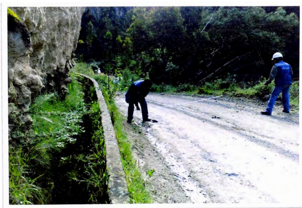
Foto N° 2: Realizando el levantamiento de las secciones.
