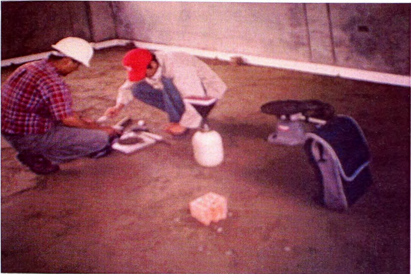
FOTO No. 25: VISTA DE ENSAYO DE DENSIDAD DE CAMPO EN AULAS
