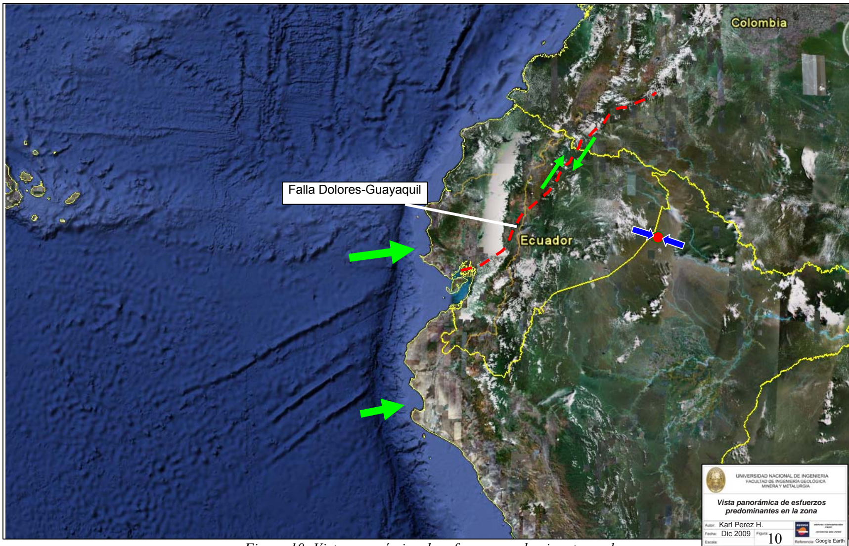
Figura 10: Vista panorámica de esfuerzos predominantes en la zona
