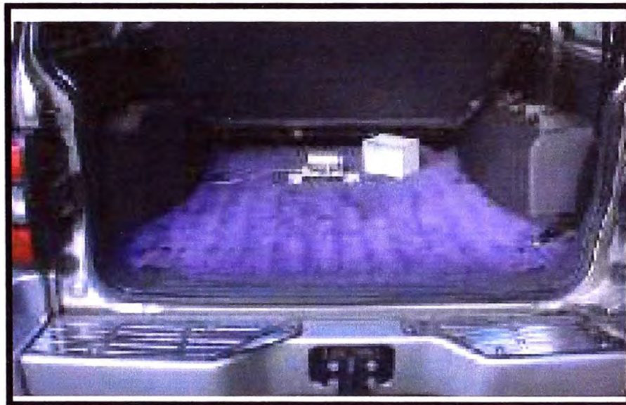
Figura N° 2.02: Instalacion de Equipo Bump Integrator
