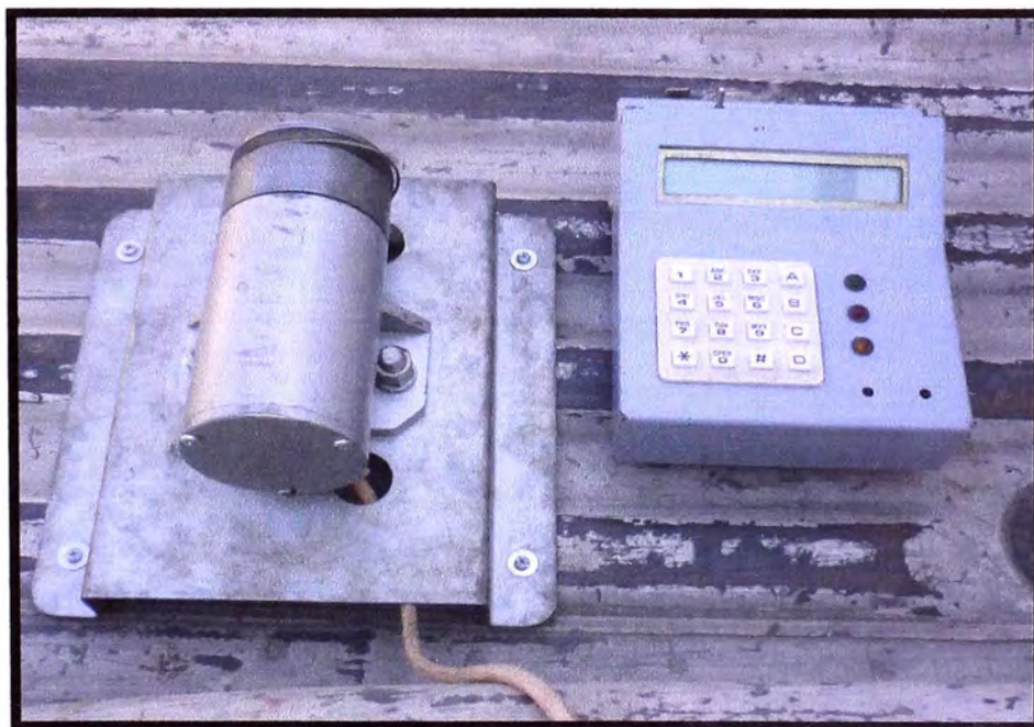
Figura N° 2.05: Equipo Bump Integrator -RETUBI
