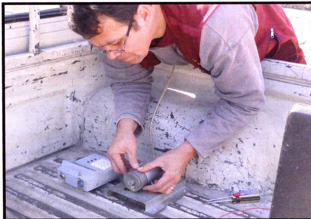
Figura N° 2.06: Instalación de Equipo Bump Integrator RETUBI
