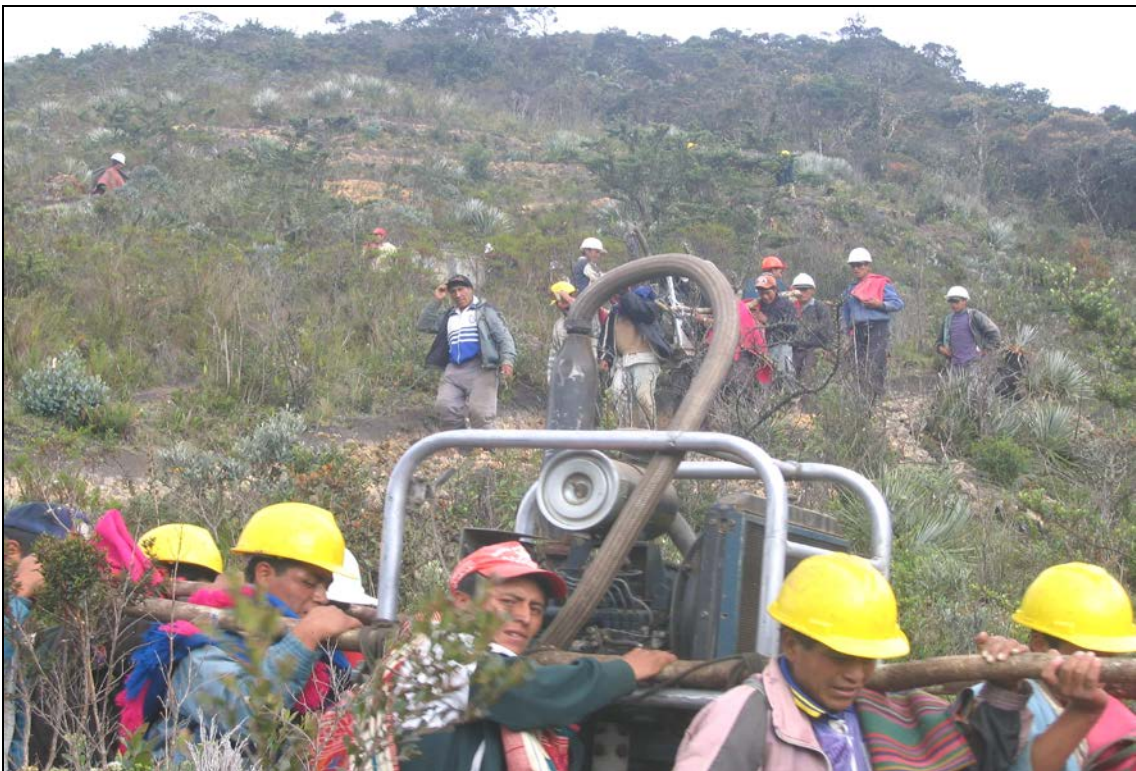
Fotografía N° 12. Transporte de los motores de la maquina perforadora desarmable Hydracore Modelo Gopher.
