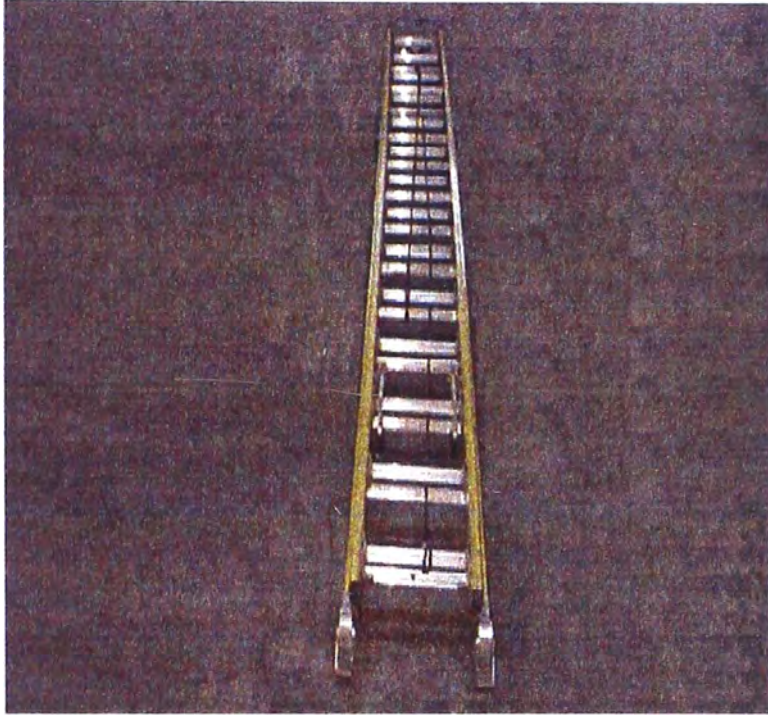
Figura N° 22.1: Escalera de 28 pasos
