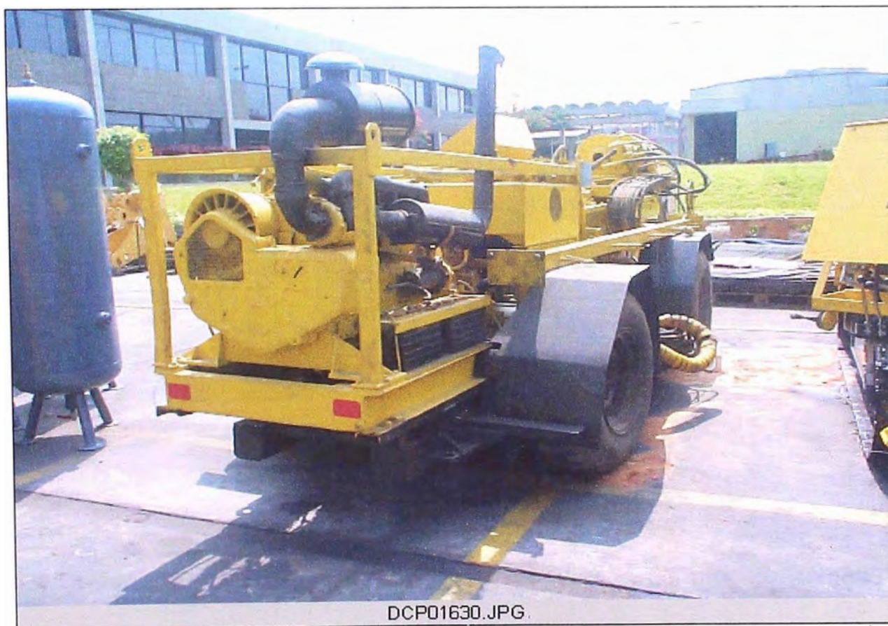
Figura N° 39.- Equipo DIAMEC montado sobre plataforma.
