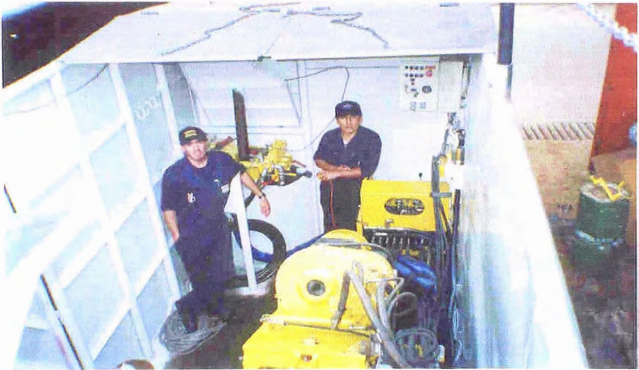
Figura N° 40.- Equipo DIAMEC montado en container.
