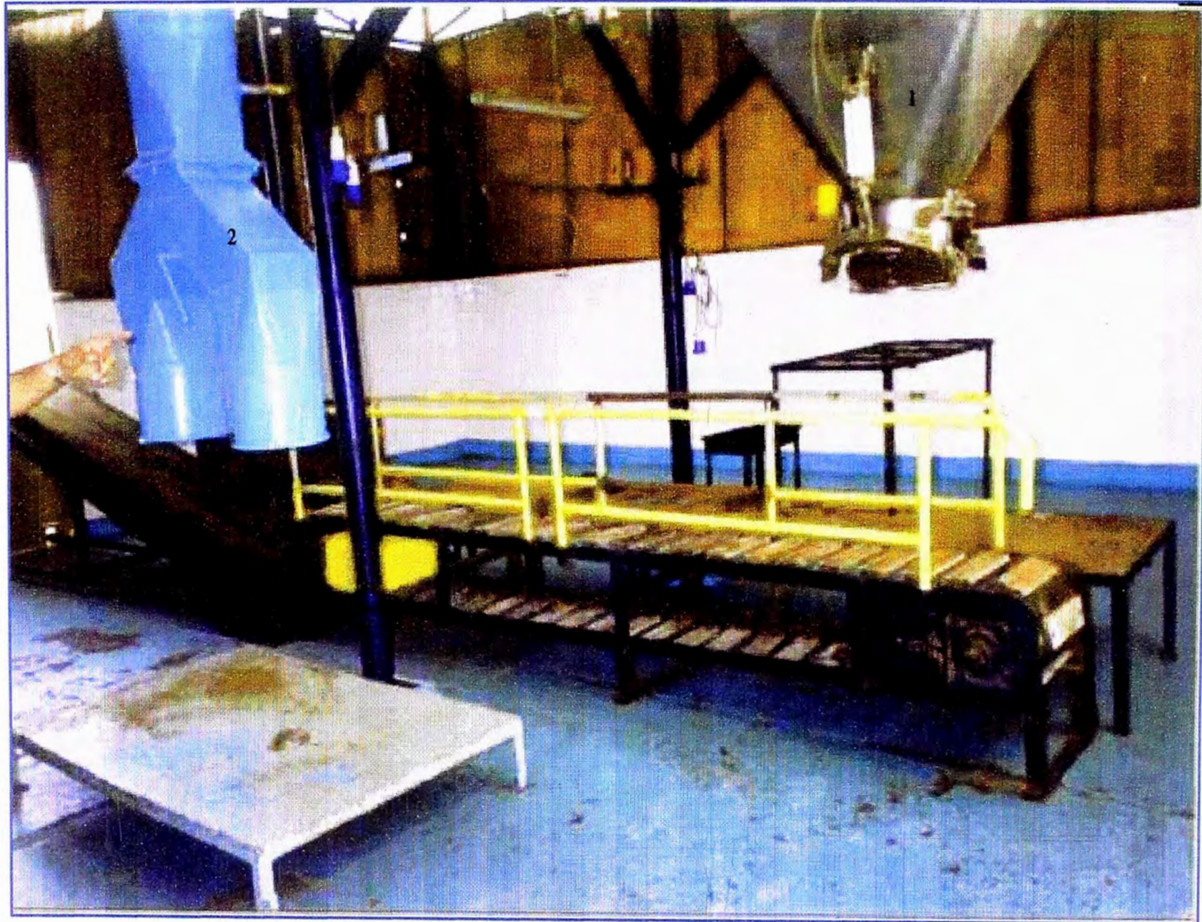
Proceso de ensaque de la harina de pescado. Vista: Ensaque Automático (1) - Ensaque Mecánico (2)
