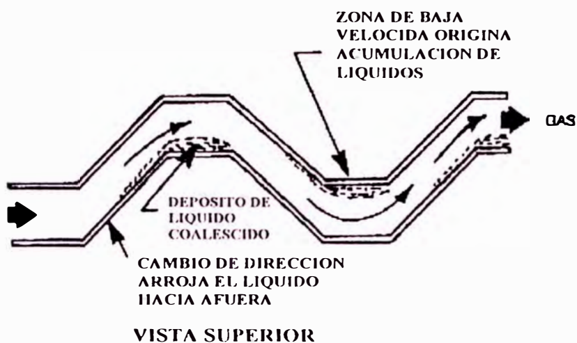
Figura: 4.4 b: Recorrido tortuoso en extractor de niebla típico
