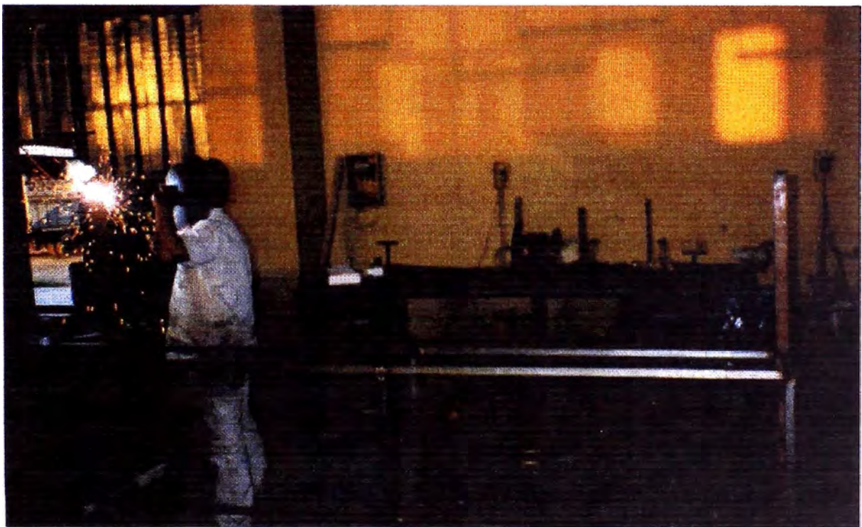
FOTO N° 24 SOLDANDO SOPORTE PARA PIZARRA GIRATORIA
