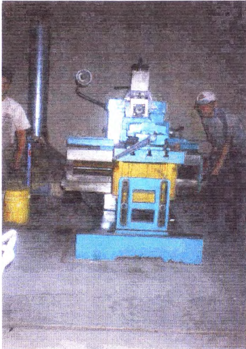
FOTO N° 7 VISTA FRONTAL LIMADORA DE CODO (CEPILLO) B60100
