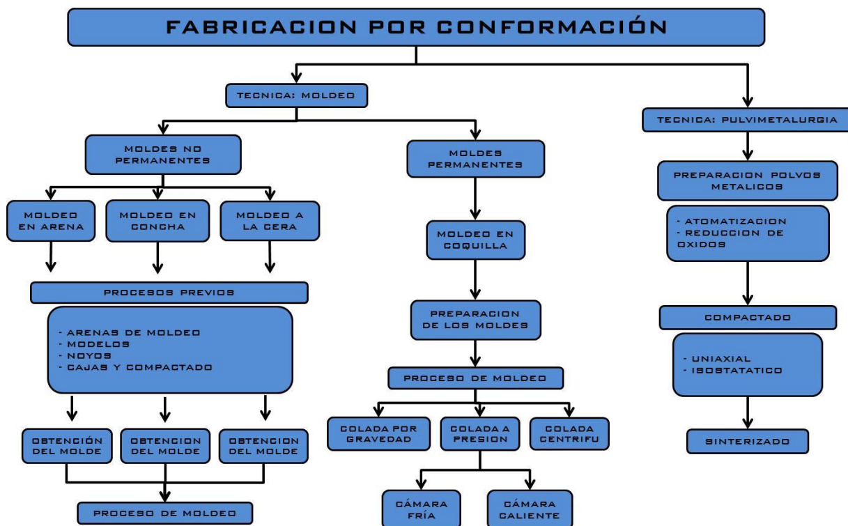
Figura 2.1. Fabricación de moldes por conformación
