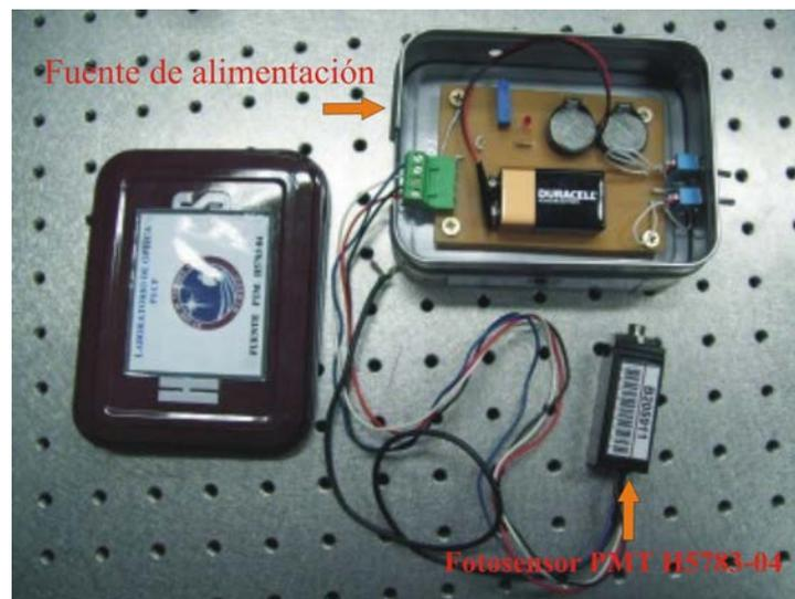
**Figura 4.19 Foto de la fuente de alimentación para el fotosensor PMT H5783-04**
