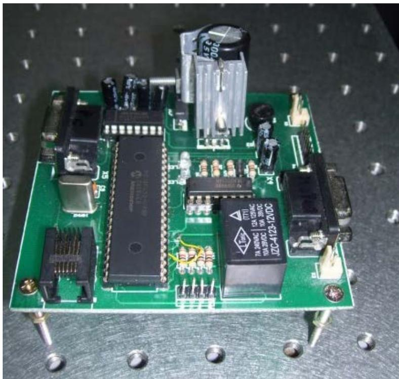
**Figura 4.21** Foto de la tarjeta de control para el monocromador **JOBIN YVON H-25**.
