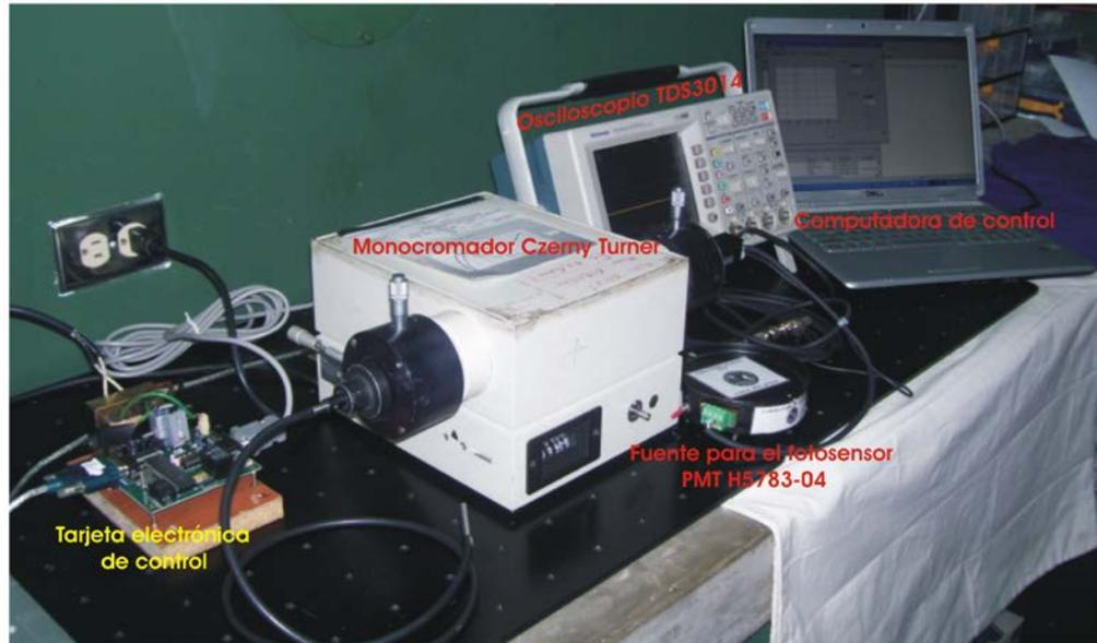
**Figura 4.22 Foto del sistema de automatización para el monocromador JY H-25.**
