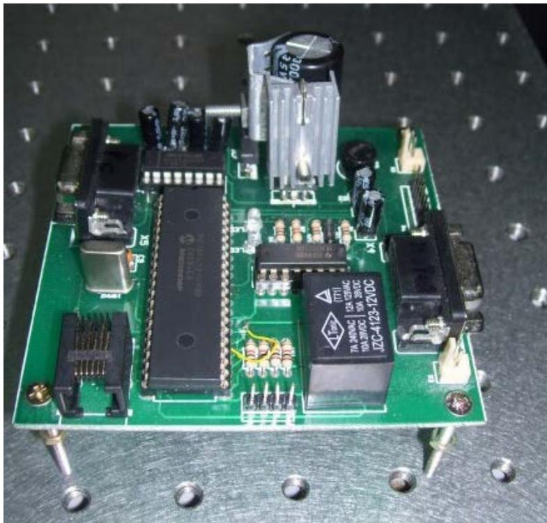
**Figura A.1 Foto de la tarjeta de control para el monocromador JOBIN YVON H-25.**
