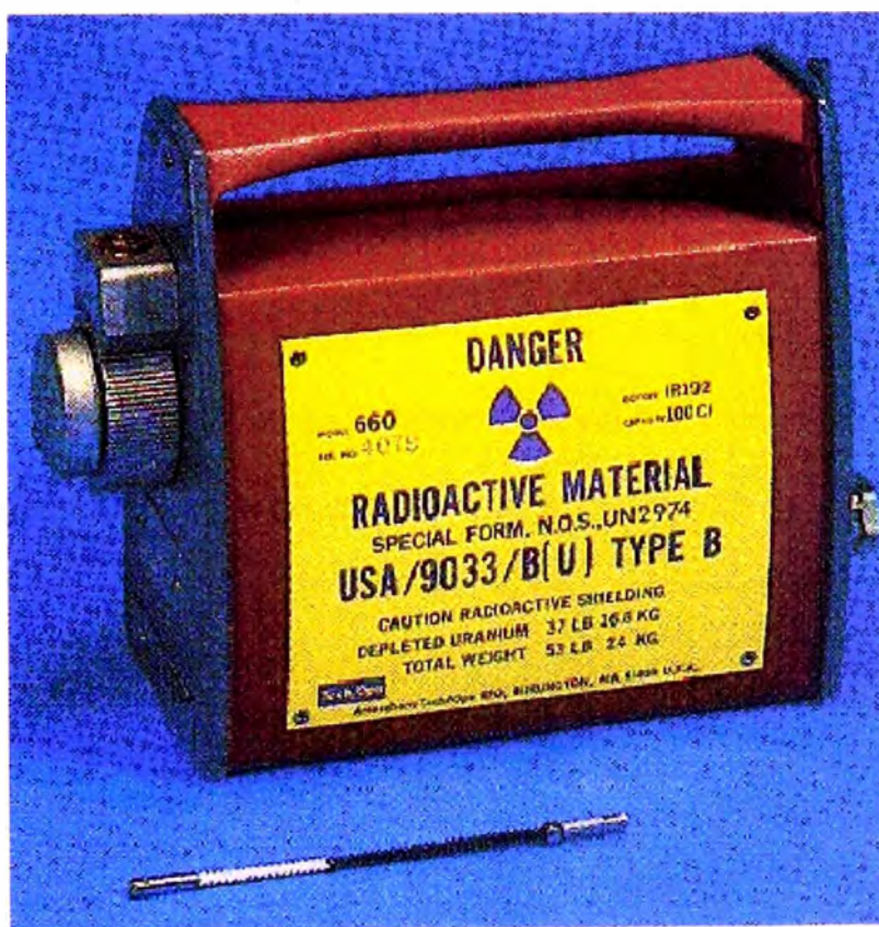
Figura 6. Equipo de Gammagrafia Iridio 192.
