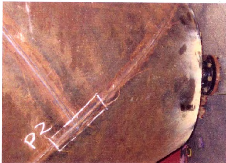
Figura 11, Identificación de la unión de soldadura.
