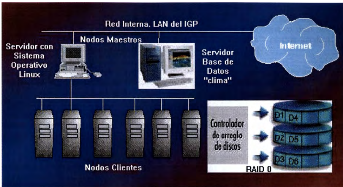
Figura 5.1. Arquitectura Cluster de Beowulf
