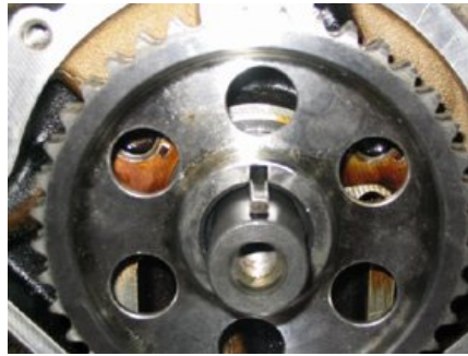
Fig. 3.31 Montaje de chaveta media luna
