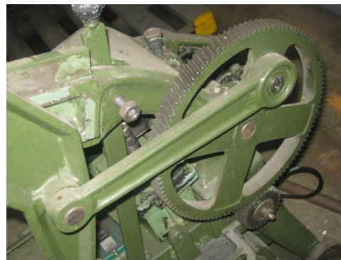
Fig. 4.5 Mecanismo de en una sierra vaivén
