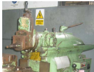
Fig. 4.8 Sistema oscilante en una maquina cepilladora de codo.
