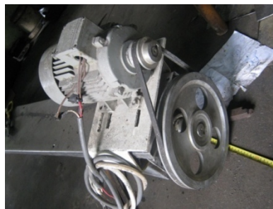
Fig. 4.7 Transmisión por faja en V de un gusano transportador para alimentos
