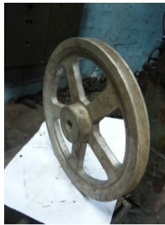
Fig. 3.50 Polea de aluminio tipo “V”
