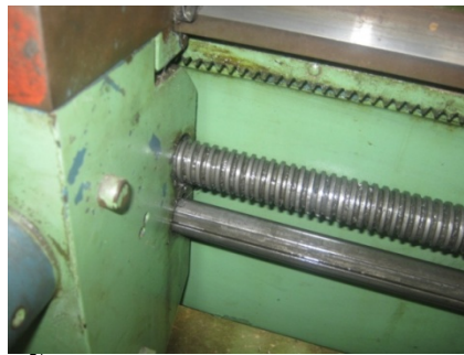
Fig. 3.24 Tornillo patrón de un torno C8DM METALYK
