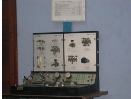
Fig. 3.7 Módulo de neumática DEGEM SYSTEM
