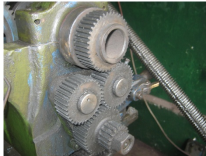
Fig. 4.6 Mecanismo de engranajes en un torno
