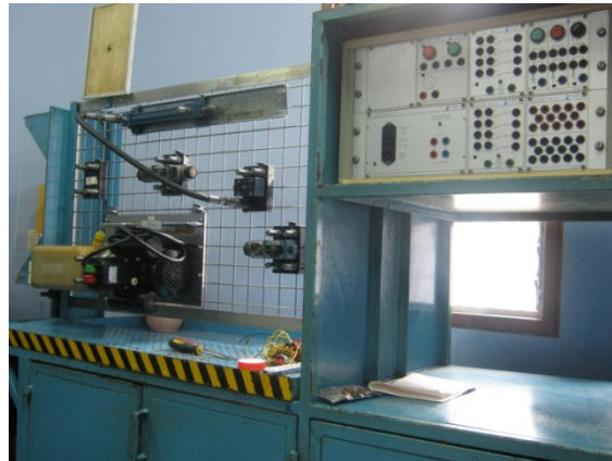
Fig. 3.5 Módulo de electro-hidráulica REXROTH
