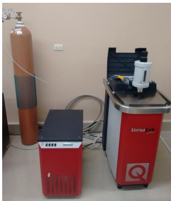
Figura 2.17 – PPMS de Quantum Design equipado con magneto superconductor de 5T. Este equipo pertenece al Laboratorio de Difracción de Rayos X (Ambientes S2, S3 y S4) de la UNMSM.
