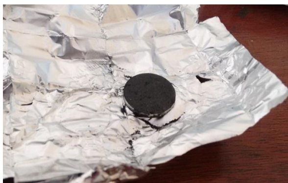
Figura 2.19 – Pastilla obtenida después 25 min a una presión de 166.67 barn. También se observa un brillo metálico en los bordes.
