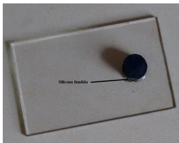
Figura 2.12 - Pastilla de YBCO sujeta al portaobjeto.
