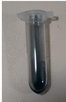
Figura 2.8 – Polvos de YBCO diluidos en alcohol etílico
