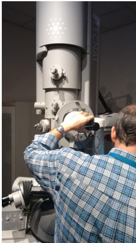
Figura 2.11 - Introducción del soporte portamuestras en la cámara del equipo MET.
