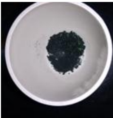
Figura 3.6 – Polvos obtenidos después del tratamiento térmico a 920 °C. Se observa partículas de color verde claro los cuales pertenecería a la fase Y211.
