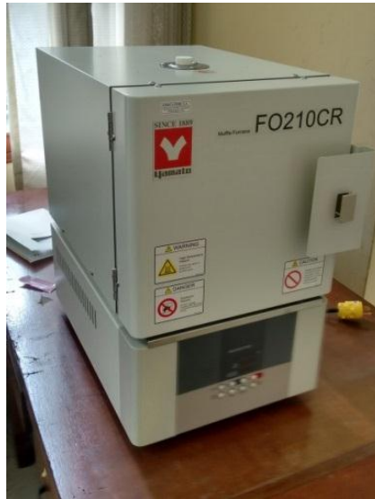
Figura 3.4 – Mufla con temperatura máxima de 1160°C. Laboratorio de física de DOCIMASIA.
