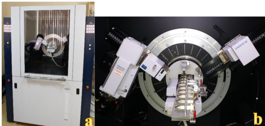
Figura 3.38: Difractómetro de rayos X marca Bruker modelo 8D Advance: (a) Vista frontal del equipo; (b) Sistema del equipo donde se coloca e irradia las muestras.
