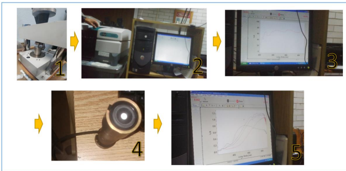
Figura 3.23: Proceso seguido para obtener el espectro de absorción (en u.a.) de las muestras estudiadas. (1) Instrumento para empastillar; (2) Sistema para obtener espectro; (3) Calibración del Cary 5 000; (4) Instrumento para colocar las muestras empastillado; (5) Espectros de las muestras tratadas.
