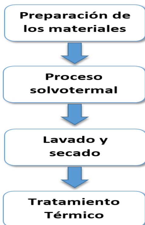
Figura 3.1: Esquema del proceso seguido en la síntesis y el tratamiento térmico de la nanopartícula \text{NaYF}_4: \text{Yb}^{3+}, \text{Tm}^{3+} .
