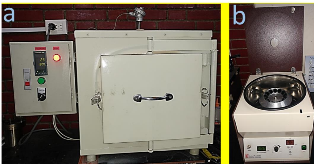
Figura 3.3: Equipos para la síntesis de nanopartículas (a) Horno para el proceso solvotermal y tratamiento térmico con un controlador marca Eurotherm modelo 2408f; (b) Equipo Centrifugadora PLC – 012E.
