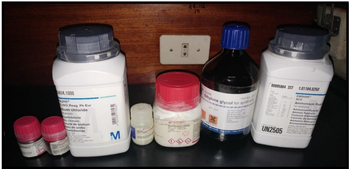
Figura 3.4: Compuestos químicos utilizado en el proceso de síntesis de \text{NaYF}_4: \text{Yb}^{3+}, \text{Tm}^{3+} .
