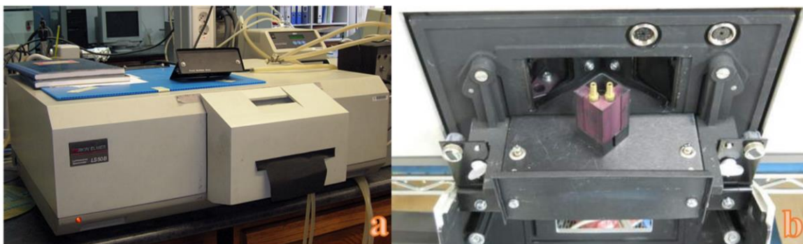
Figura 3.31: Equipo Perkin Elmer LS50B: (a) Vista frontal del equipo; (b) Vista de una parte del equipo donde se posicionan las muestras.
