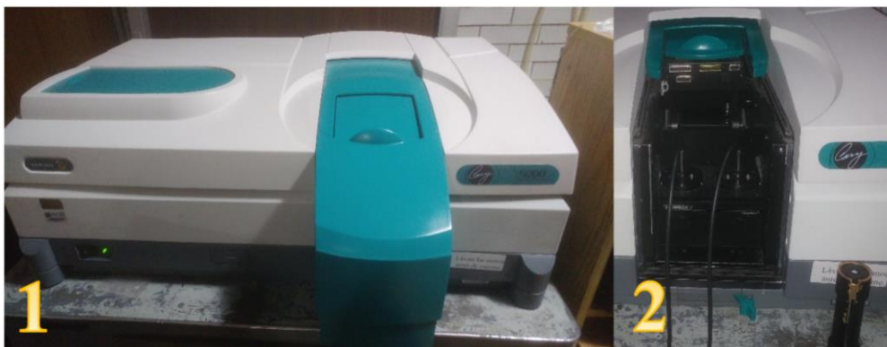
Figura 3.22: Espectrofotómetro UV/VIS/NIR Cary 5 000. (1) Vista frontal de equipo Cary 5 000; (2) Parte del sistema donde se recopilan los datos de las muestras.
