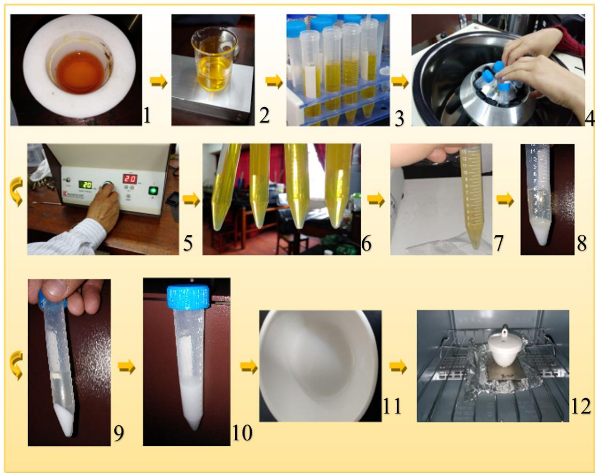
Figura 3.7: Lavado y secado de la muestra: (1 y 2) Producto final luego de la etapa en el horno; (3) Muestra vertida en los tubos de centrifuga; (4 y 5) Proceso de centrifugado; (6 - 10) Precipitación de la muestra por el lavado y centrifugado; (11) Muestra en crisol; (12) Muestra en proceso de secado.
