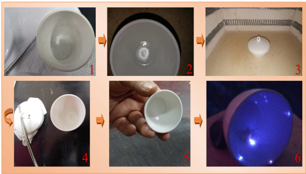
Figura 3.8: Figura donde se observa: (1) y (2) Muestras secadas; (3) Muestra en el horno; (4) y (5) Muestra luego de salir del horno; (6) Muestra emitiendo luminiscencia luego de ser excitada con el láser 980 nm.
