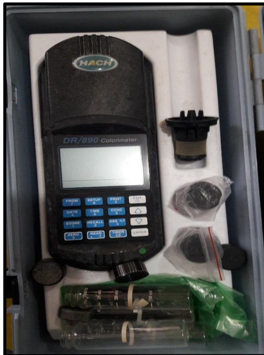
Figura 53. Oxidómetro, equipo de medición de OD
