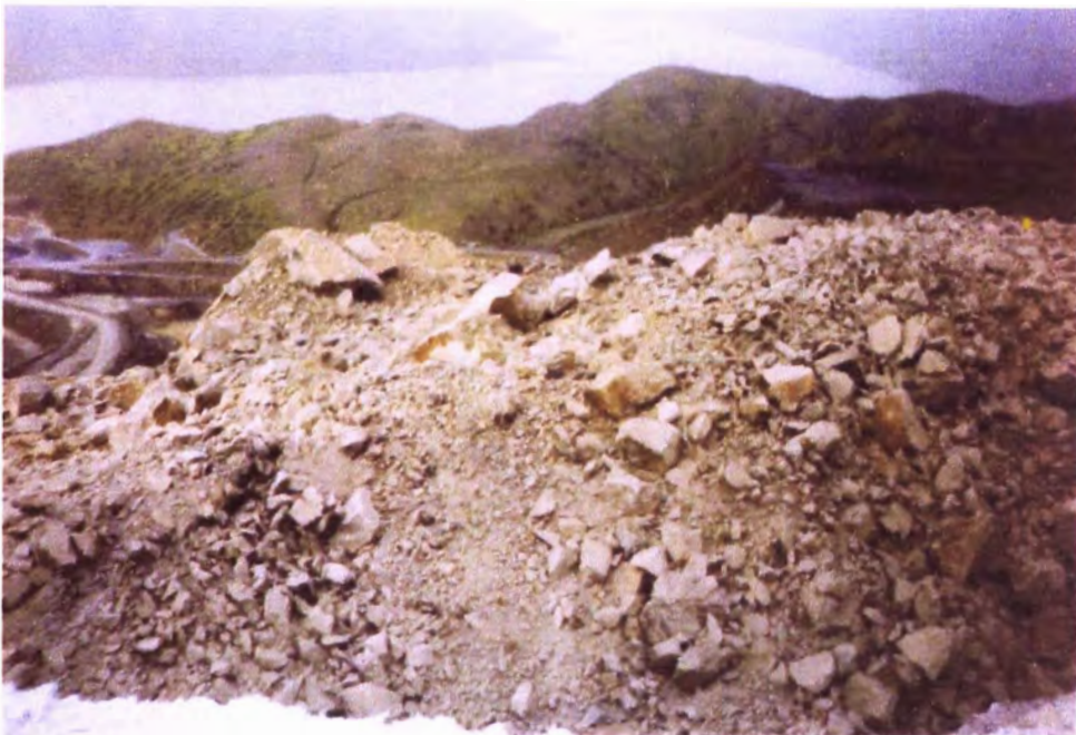
Figura 2,3: Muestra la fragmentación del macizo rocoso (Fuente Clases Voladura de Rocas UNI)
