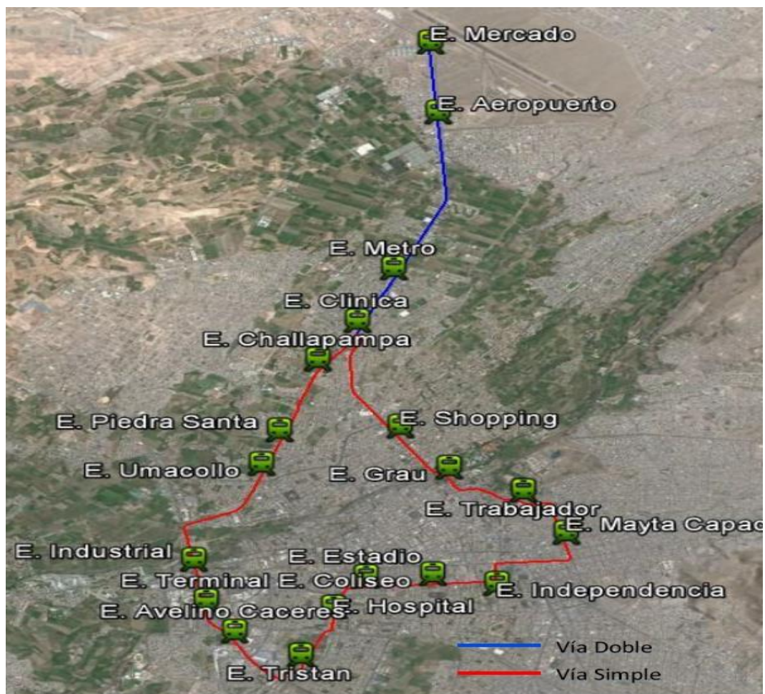
Figura N° 5.1 Trazo de la vía - Monorriel
