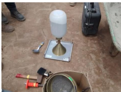
Figura N° 30 Ensayo de cono de arena
