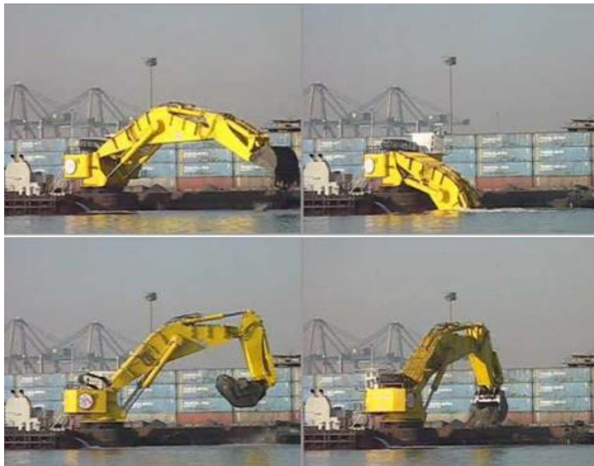
Figura N° 12 Funcionamiento de la draga retroexcavadora
