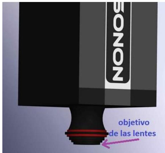
**Figura 32.-** Objetivo de las lentes con un anillo regulador de la distancia focal que se regula para un mejor enfoque de la muestra.
