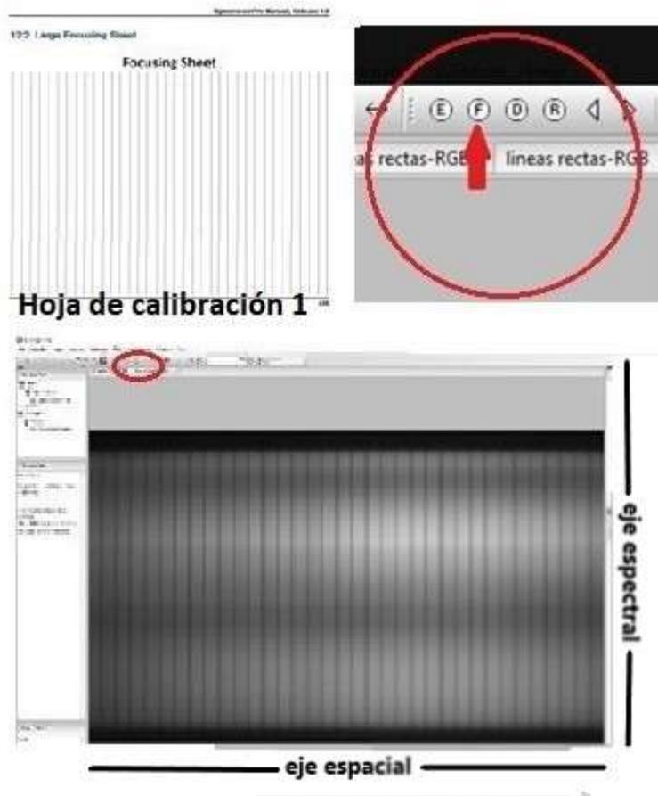
**Figura 33.-** Elementos usados en la calibración del objetivo de las lentes. La parte superior izquierda muestra la hoja de calibración 1. La parte superior derecha muestra el botón F. La inferior muestra el enfoque de la cámara sobre la hoja de calibración 1.
