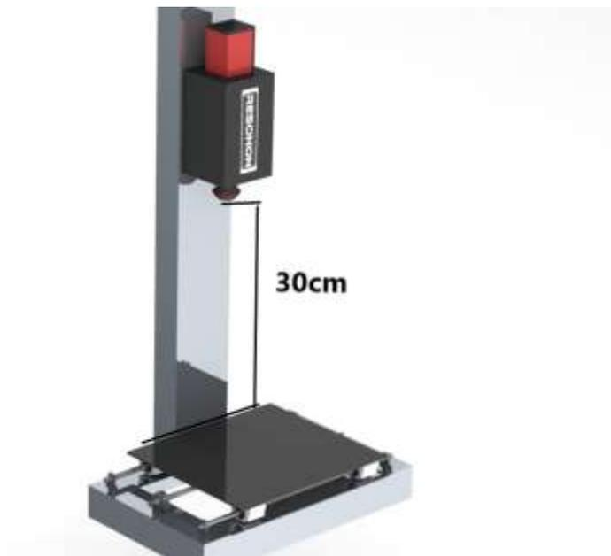
**Figura 24.-** Montaje de la cámara hiperespectral sobre el soporte de aluminio a 30 cm de la plataforma móvil.
