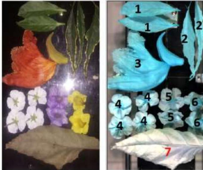
**Figura 41.-** Imágenes registradas con una cámara convencional y RESONON PIKA NIR 320 de un conjunto de flores y hojas. La imagen de la izquierda es la RGB tomada con una cámara digital y la de la derecha corresponde a una imagen en falso color de la misma escena con R = banda 123, G = banda 83, B = banda 43.
