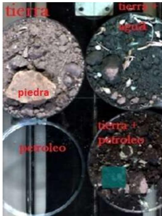
**Figura 54.-** Muestras evaluadas: muestra de tierra (y piedra), muestra de tierra con agua, y muestra de tierra con petróleo.
