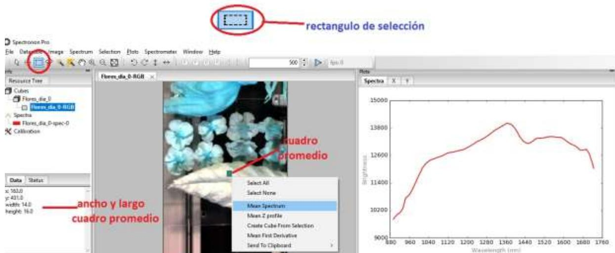
**Figura 43.-** Espectro de reflectancia correspondiente al promedio tomado sobre el grupo de pixeles remarcado en la figura. Se muestra también la opción “rectángulo de selección” del software SpectronPro que permite elegir la sección rectangular sobre la cual se evaluará el promedio del espectro de reflectancia.
