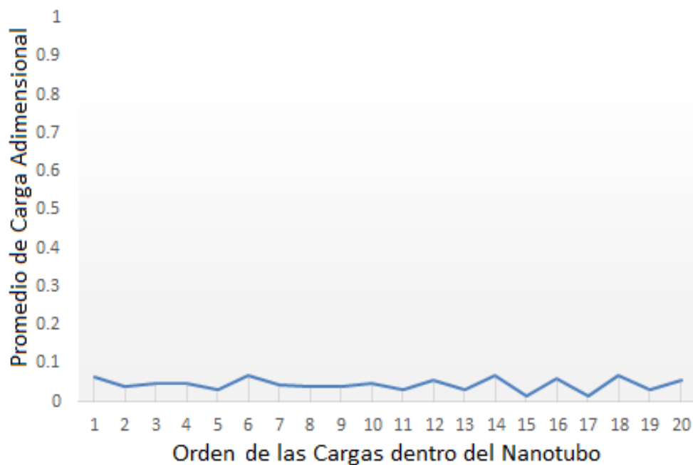
Figura 35: Promedio de carga eléctrica adimensional a lo largo del nanotubo. Los valores son ligeramente mayores que en el caso anterior debido a la presencia de la carga impuesta en las paredes del nanoporo tubular.
