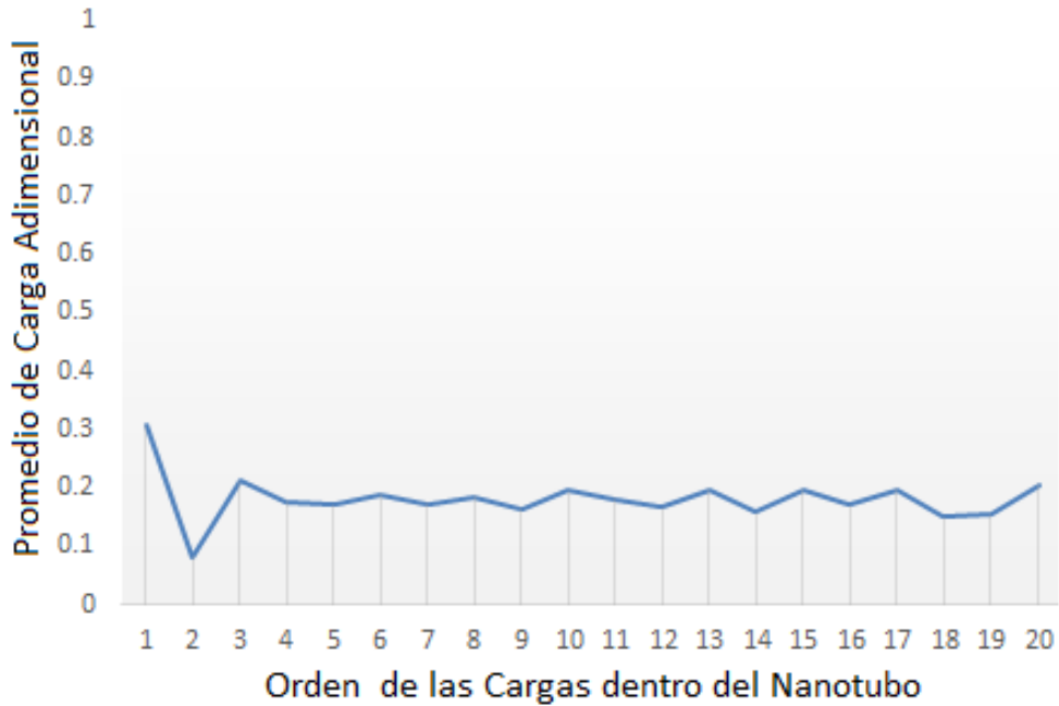
Figura 36: Promedio de carga eléctrica adimensional, obtenida a partir del programa en lenguaje C++ para una carga eléctrica adimensional de 0.05. Se observa que los valores obtenidos son mayores que en el caso anterior.
