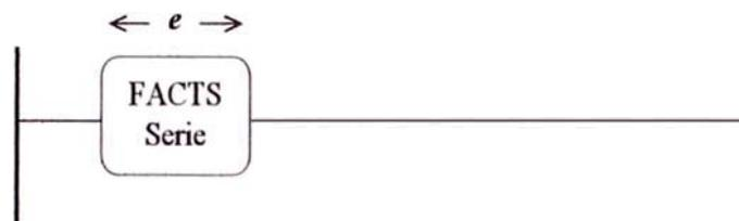
Fig. 3.3: Configuración de controlador tipo Serie
