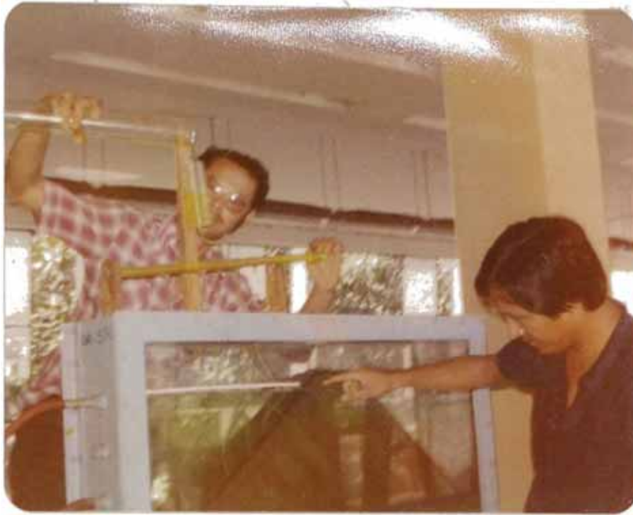
Fótoqr. 9.- Se continua llenando fluoresceína en el recipiente, pudiéndose ver que ya se van dibujando las líneas de corriente.
