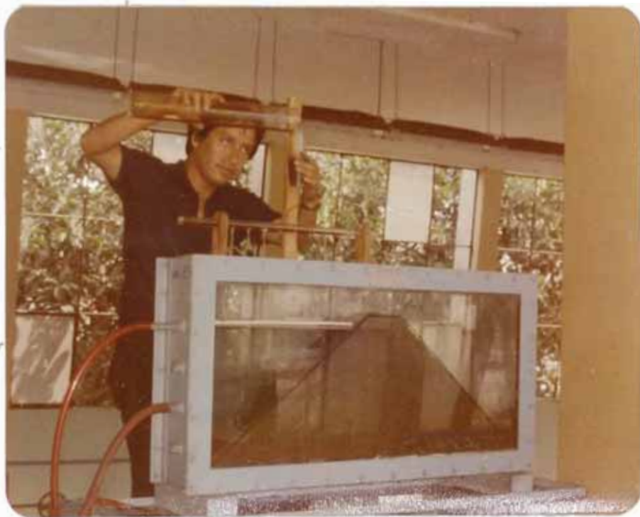
Fótoqr. 8.- Se observa el llenado de la fluoresceína una vez llegada el agua a la altura h para el trazado de las líneas de corriente.
