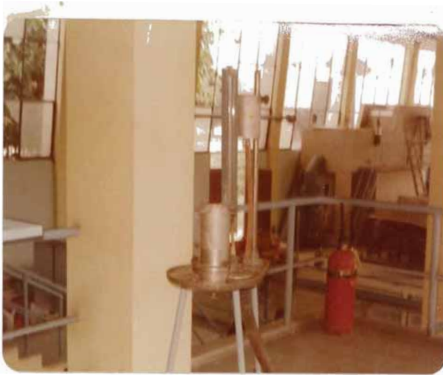
Fótoqr. 1.- El Permeámetro tipo Darcy tal como se encontró en el Laboratorio Nacional de Hidráulica.
