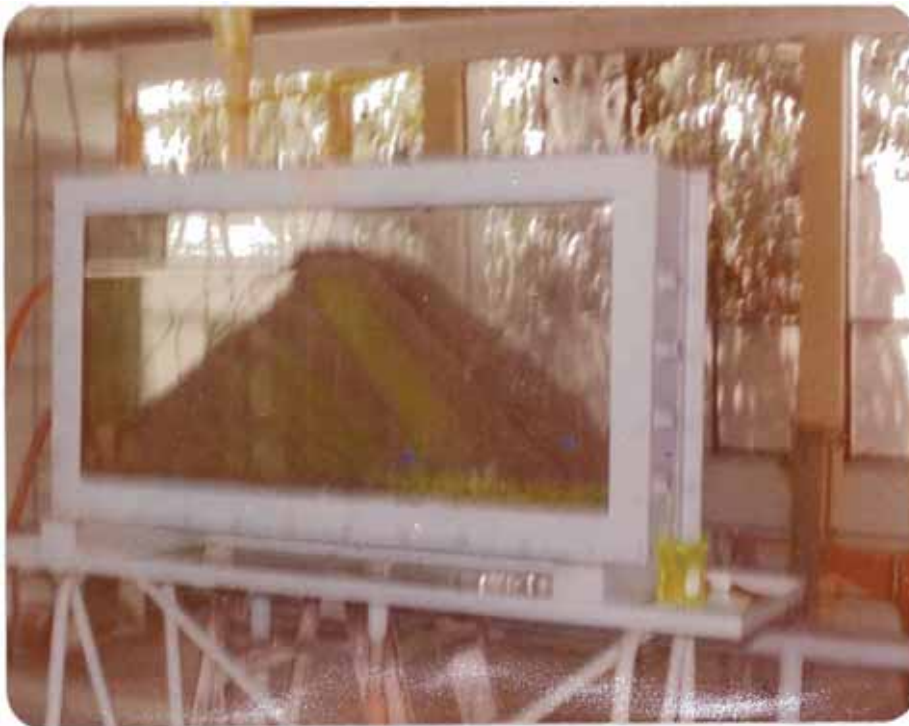
Fótoqr. 9.- Se continua llenando fluoresceína en el recipiente, pudiéndose ver que ya se van dibujando las líneas de corriente.
