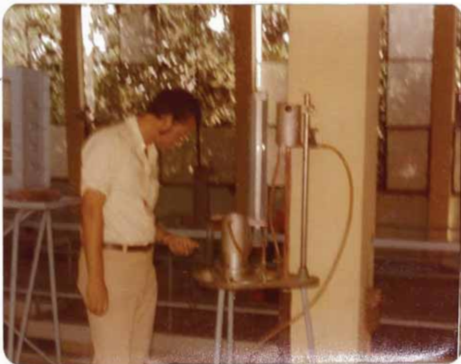
Fóto gr. 3 y 4.- Se indica el volumen de agua que ha pasado a través del suelo (con la prob e -ta de 100 cm 3 ), y el tiempo que se dem o -stra para hallar el caudal de filtración.
