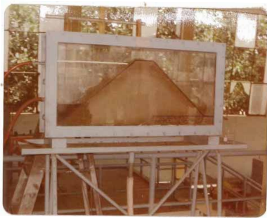
Fótoqr. 7.- Presa con filtro horizontal; el agua comienza a subir hasta el límite fijado.
