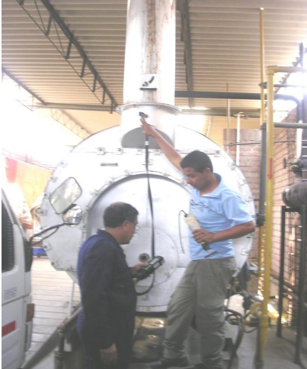
**Medición con Analizador de Gases en una Caldera**
