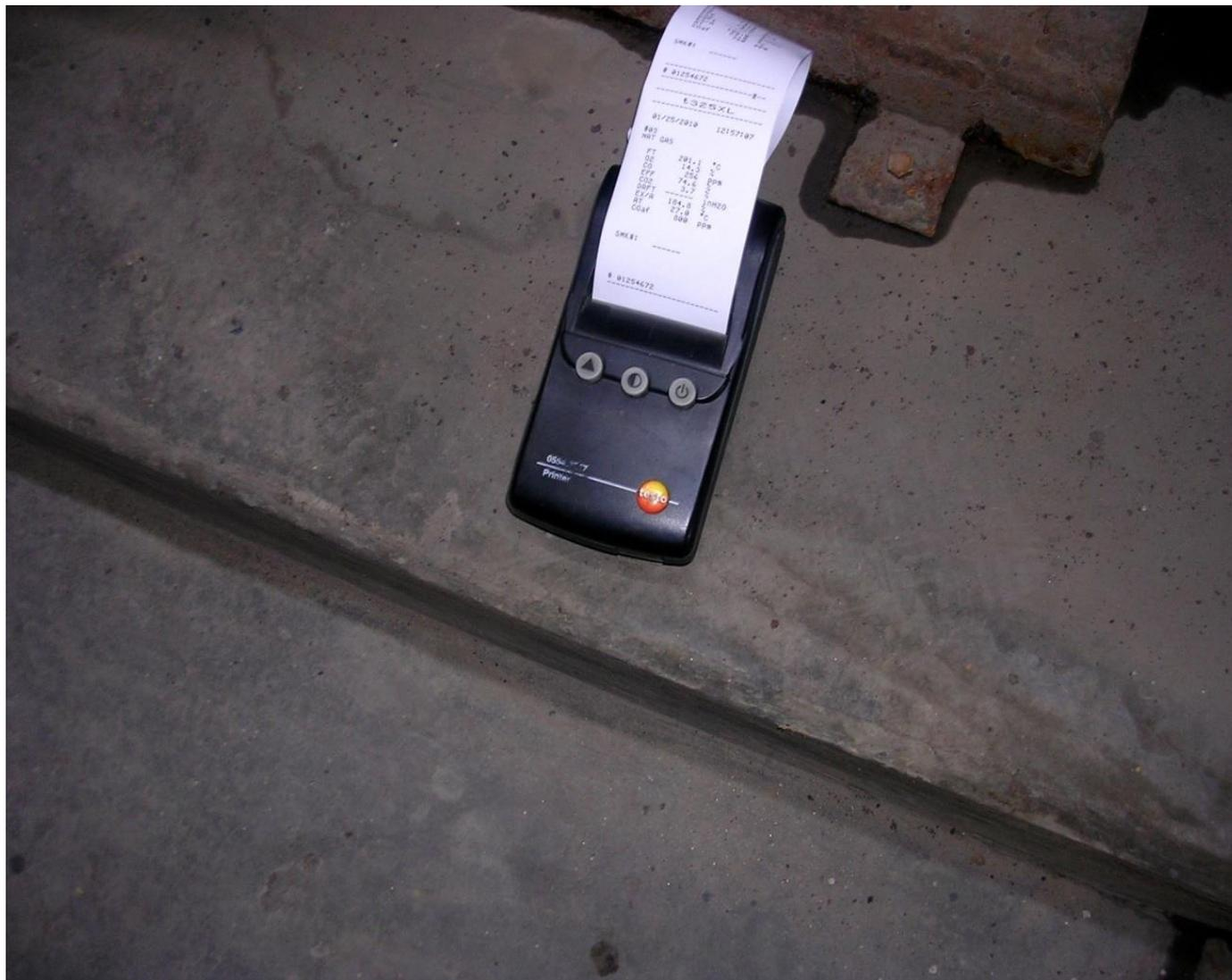
Impresión de parámetros de medición - Analizador de Gases con Impresora Testo
