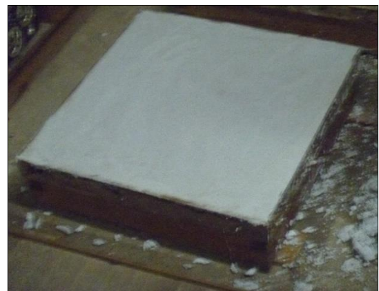
Revestimiento primario de mortero de cemento y tierra tamizada C:T/1:4
