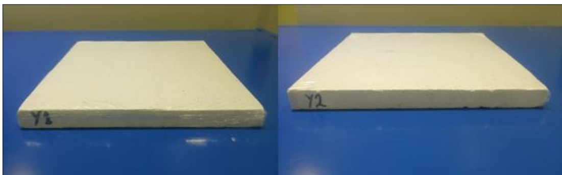
Figura N°5.19 Muestras de yeso Y1 y Y2 de 25 cm x 25 cm x 1.97 cm
