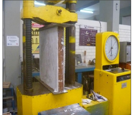
Montaje del panel de ensayo a la máquina de compresión
