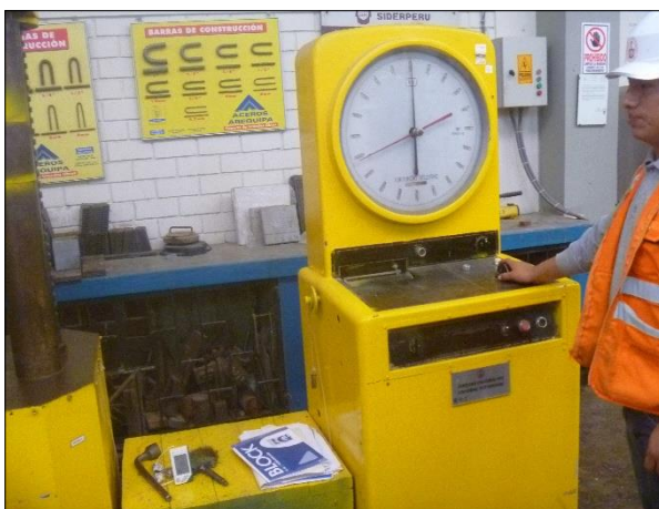
Aplicación de la carga de forma incremental
