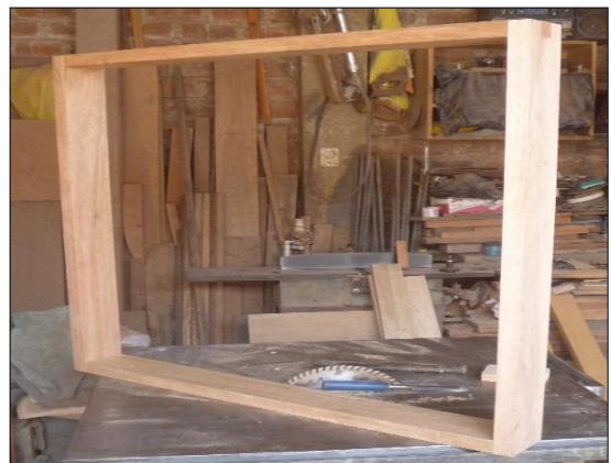
Unión de elementos verticales y horizontales
