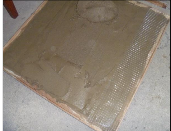
Revestimiento primario de mortero de cemento y tierra tamizada C:T/1:4
