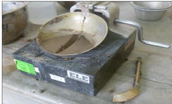
Figura N°5.4 División de la mezcla de suelo en dos porciones en la copa de Casagrande con ayuda del acanalador.
