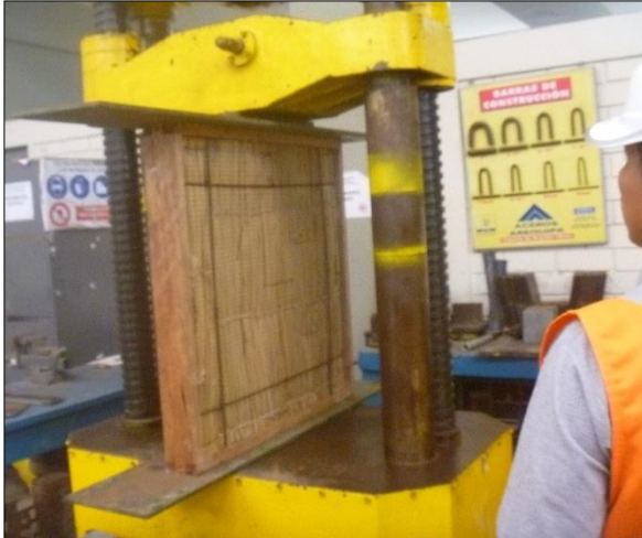
Montaje del panel de ensayo a la máquina de compresión
