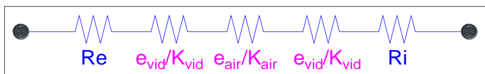
Figura N°5.35 Representación del circuito térmico del doble vidrio
