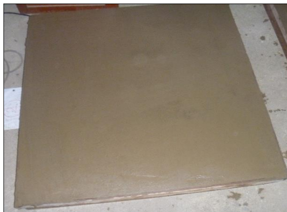
Revestimiento primario de mortero de cemento y tierra tamizada C:T/1:4
