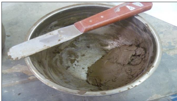
Figura N°5.3 Preparación de la mezcla para su colocación en la Copa de Casagrande.
