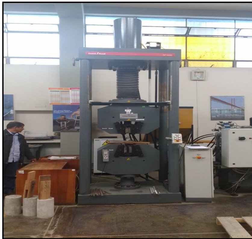
Fotografía N° 5.4- Máquina Zwick Roell de 100 toneladas
