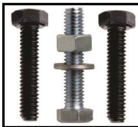
Figura N° 3.9. Perno hexagonal grado 2, zincado. Usado en nuestro sistema emperrado, de 1/4" de diametro y 2.5", 4" de largo. Norma ASTM A 307, grado A.
