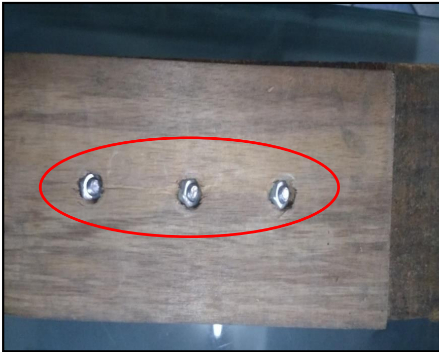
Fotografía N° 5.5- Madera Cumala ensayada con tres pernos.
