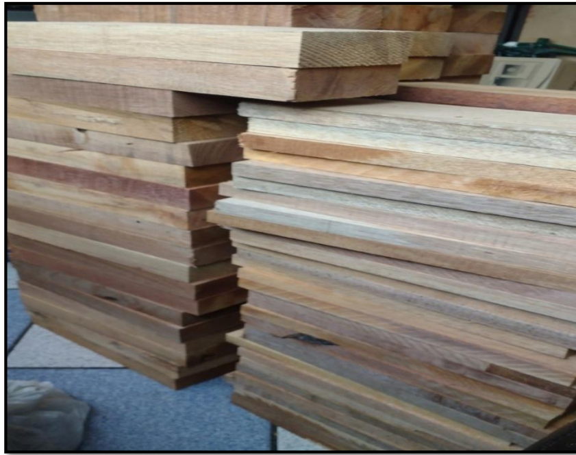
Fotografía N° 5.11- Habilitado de las piezas según dimensiones.
