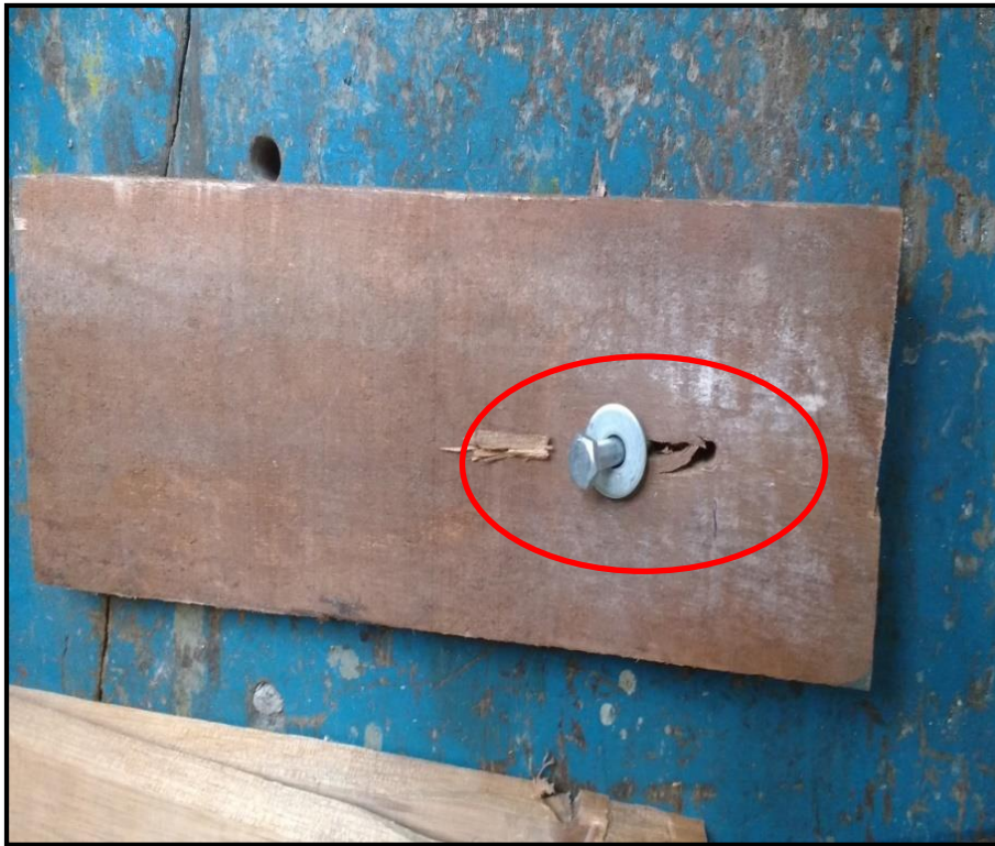
Fotografía N° 5.6- Deformación final de perno en muestra ensayada.
