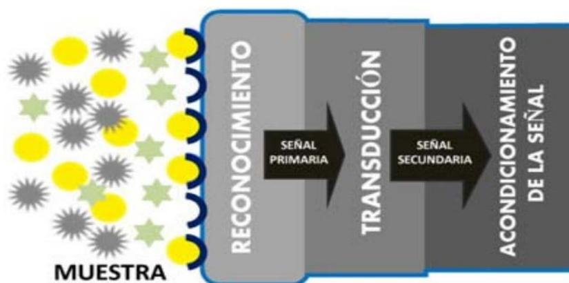
**Figura 2.** Esquema de los componentes de un sensor.
