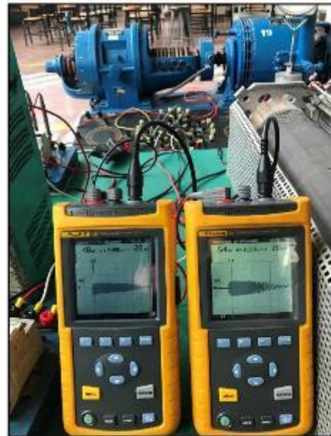
Fig. 18. Vistas del motor de inducción utilizado y del sistema de medición, observándose las formas de onda de las corrientes de líneas trifásicas del estator y el rotor.
