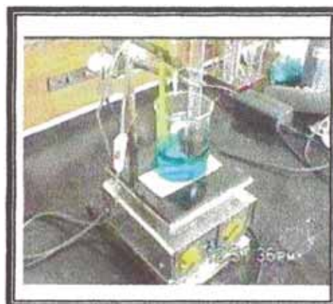
Fig. 18 Instalación de la celda para la deposición de Ni-P
