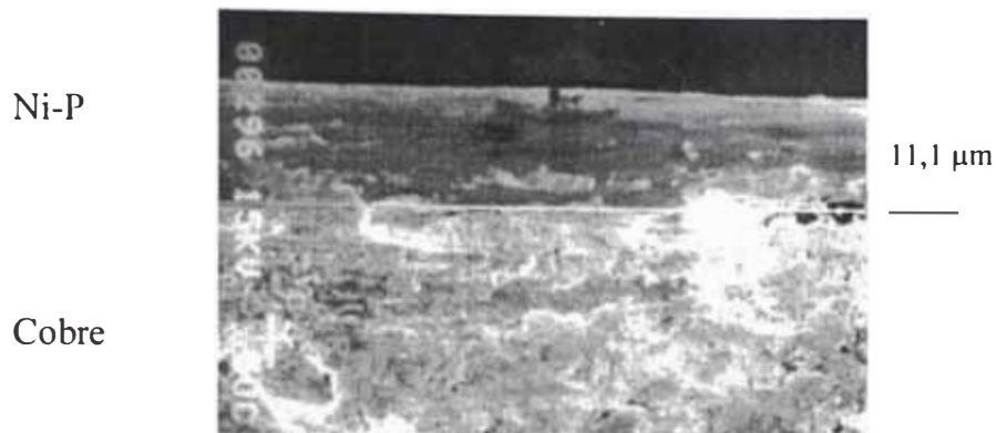
Fig. 71 Micrografía, magnificación 10,000 X, medición del espesor de depósito
