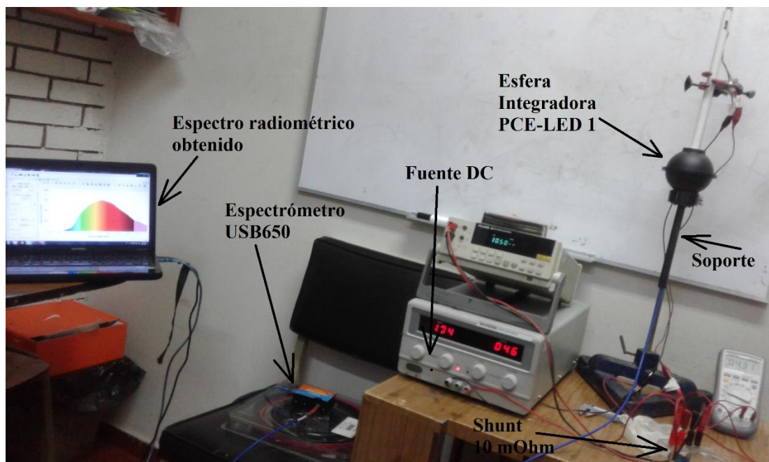
Figura 33: Sistema de medición montado empleando la esfera integradora PCE-LED 1 y el espectrómetro USB650.
