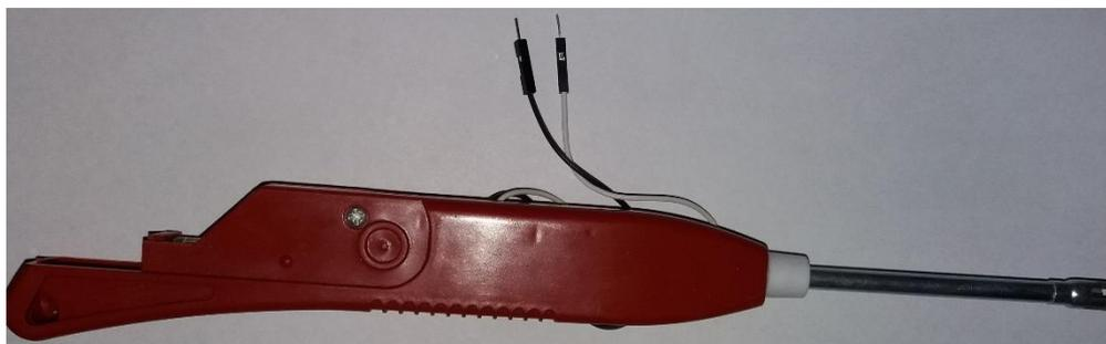
**Figura 4.5** Encendedor eléctrico como sistema de ignición
