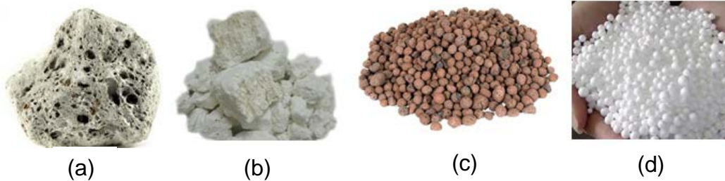
Figura N° 2 Agregados ligeros naturales como (a) pumita y (b) diatomita, y artificiales como (c) arcilla expandida y (d) perlita expandida.
