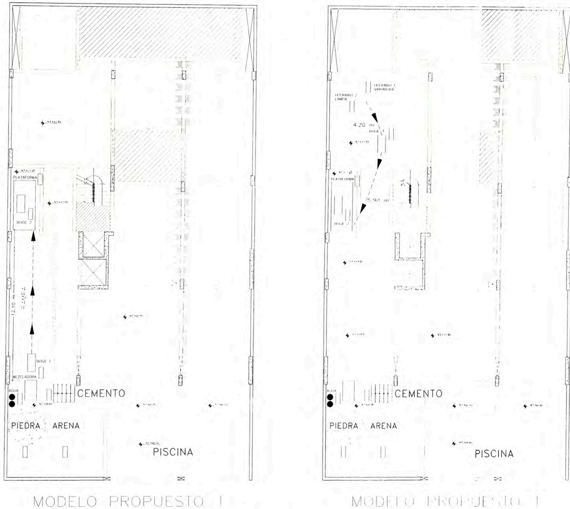
Figura 4.11: Primera distribución propuesta en obra para los materiales y equipos para la partida de vacado de concreto en vigas y losa.
