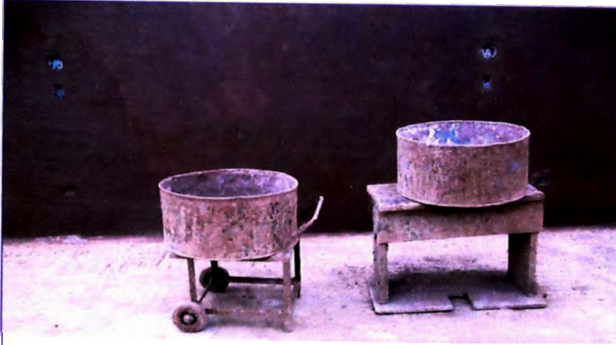
Fotografía 4.28: Porta batea móvil (izquierda) y apoyo tradicional (derecha) hecho por los mismos obreros, algunas veces de madera otras de ladrillos.
